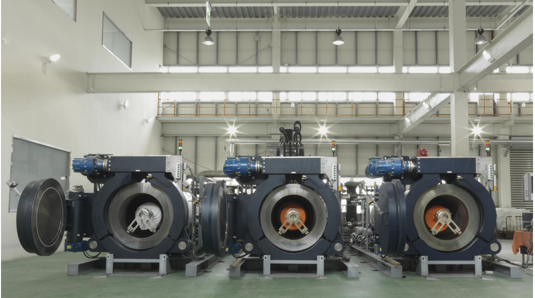
Resim 3.19 DyeCoo üretim merkezinde karbondiyoksitle boyama işleminin gerçekleştiği DyeOx ekipmanı
