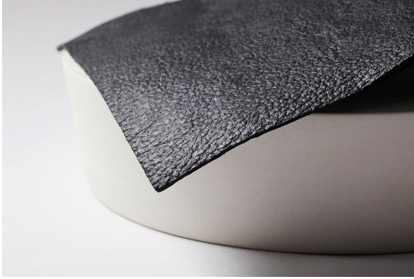
Resim 3.9 Mantar hücreleri çoğaltılarak üretilen deri görünümlü Mylo plakaları
