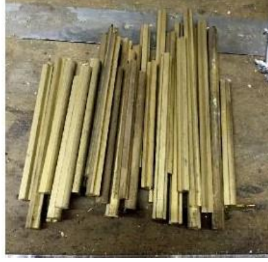
Resim 6.2.17. Pirinç profillerin kesilmesi (gövde).
