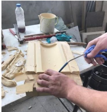
Resim 6.4.25. Hava verilerek kalıpların çıkartılması.
