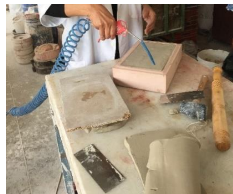
Resim 6.2.14. Havayla kalıptan ayırma işlemi.
