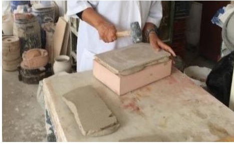
Resim 6.3.16. Çamuru sıkıştırma işlemi.
