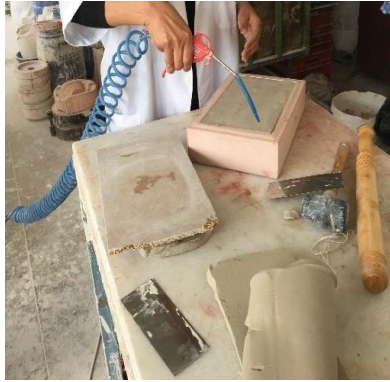
Resim 6.3.18. Basınçlı havayla kalıptan çıkarma işlemi.
