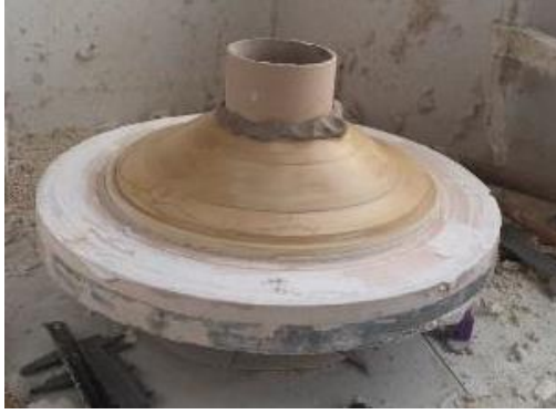
Resim 6.1.7. Kapağa çamur dökülmesi.
