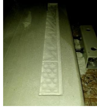
Resim 6.2.9. Elde edilen işletme kalıbı (gövde). Resim 6.2.10. Elde edilen işletme kalıbı (bordür).
