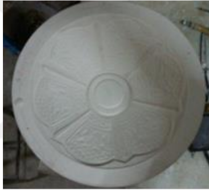
Resim 6.1.15. İşletme kalıbın çıkarılması.
