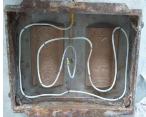
Resim 6.4.25. Hava verilerek kalıpların çıkartılması.
