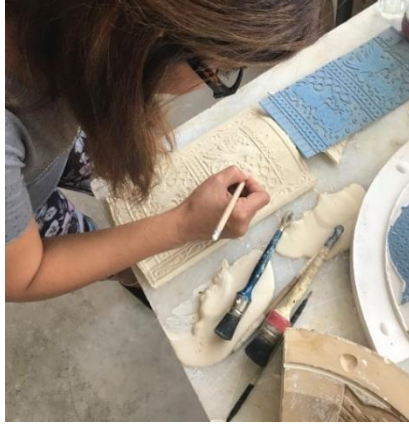
Resim 6.1.23. Desenlerin alçı kalıba aktarılması ve derinleştirilmesi.
