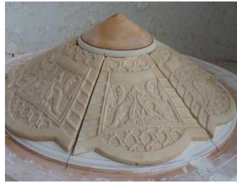
Resim 6.1.12. 6 adet ilk kalıbın model üzerine montajı.
