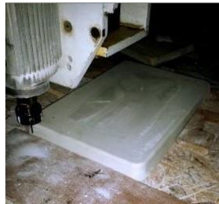
Resim 6.2.8. CNC ile desen oyma işlemi.
