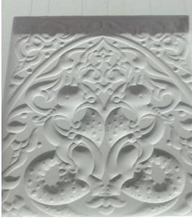
Resim 6.2.9. Elde edilen işletme kalıbı (gövde). Resim 6.2.10. Elde edilen işletme kalıbı (bordür).
