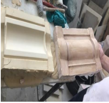
Resim 6.1.25. Çekirdek kalıba çamur dökülmesi.
