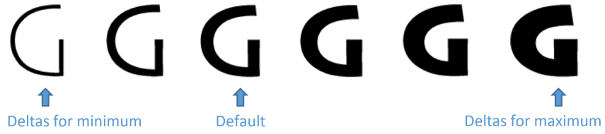
Şekil 4. 22: Varsayılan eksenler arasındaki minimum ve maksimum en son nokta deltası
