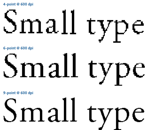
Şekil 2-28 Aynı çözünürlükte olup farklı puntolardaki görüntü (James FELICI, The Complete Manual of Typography, 285)
