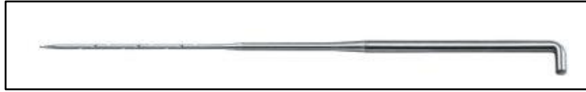
Resim 3.1.1.4.1: Keçe tekniđinde kullanılan iğne.
