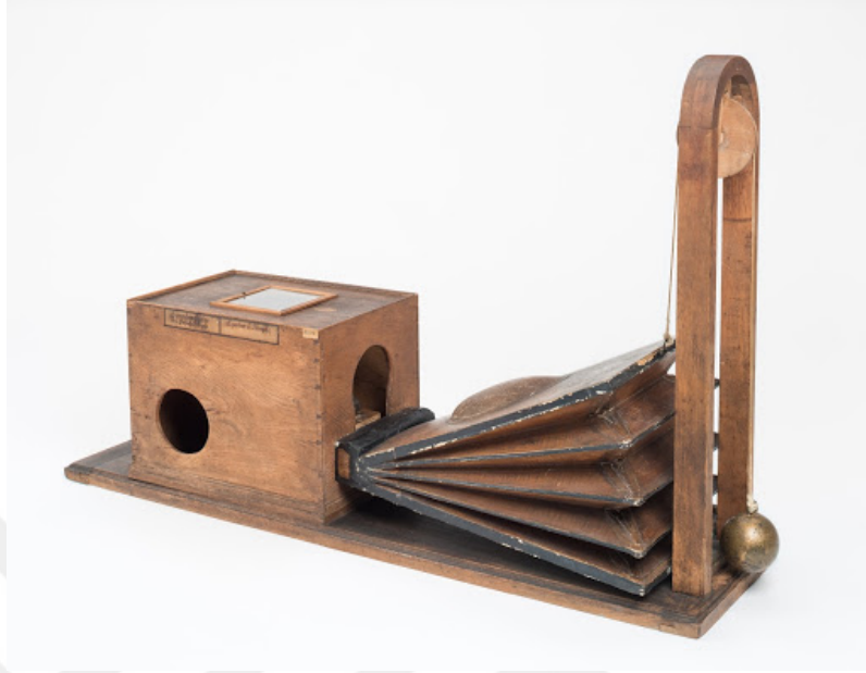
Şekil 27 Kempelen'in konuşma makinesi örneği 18. yy
