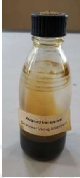
Resim 3.37. Asfalt Verniği Şişesi Asitle Oyma işlemi için eski tarihli asfalt verniği şişesi.
