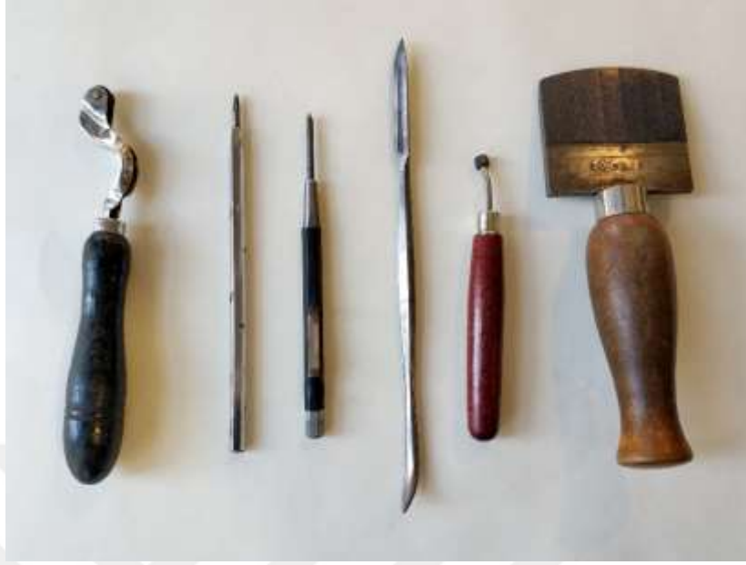
Resim 3.21. Çukur Baskı kazıma uçları (sağdan sola) Rulet, Tığ Uçlar, Üç Kenarlı Kazıyıcı ve Parlaticı, Rulet Berso/ Beşik//Dişli Bıçak (mezzotint)
