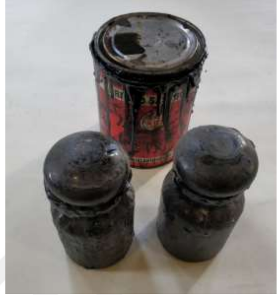
Resim 3.38. Asfalt Verniği Arı marka şasi boyası ve atölyede kullanılan asfalt verniği kapları.
