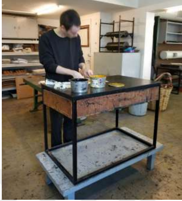
Resim 3.15. Tandır Çukur baskı yöntemleri için mürekkebin verildiği tandır (Alaettin Aksoy tarafından yaptırılmış rezistanslı alet)
