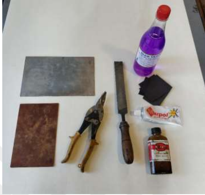
Resim 3.23. Çukur Baskı plakalarının çalışmaya hazır hale getirilmesi için araç ve malzemeler Çinko plaka, Bakır plaka, Metal Kesme Makası, Eğe, İspirto, Zımpara Kağıdı, Metal parlaticıları - Kaol ve Metal cilası.
