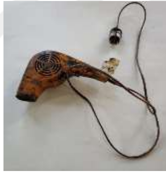
Resim 3.48. Kurutma makinesi Asfalt verniğinin kurutulması sırasında atölyede uzun yıllar kullanılmıştır.
