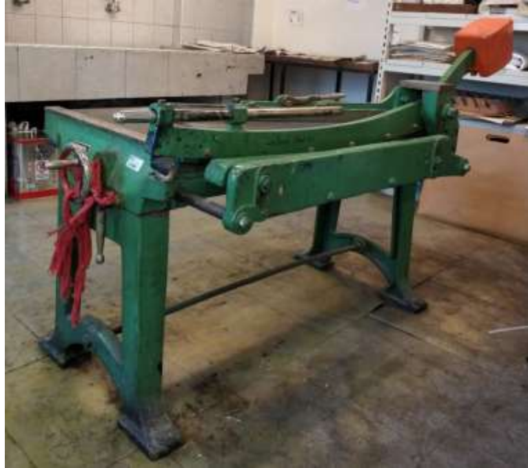
Resim 3.44. Giyotin kağıt yanı sıra linolyum ve metal kesmekte kullanılan alet.
