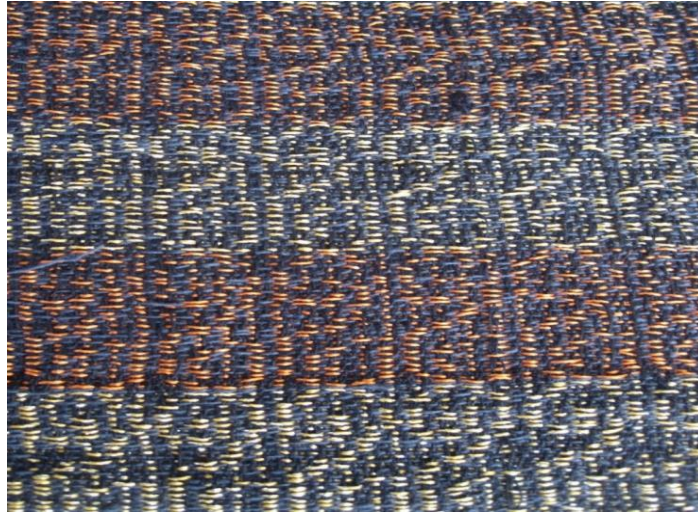
Resim 2.44.Çözüden Bağlantılı Atkıdan Takviyeli Leno Dokuma 20
