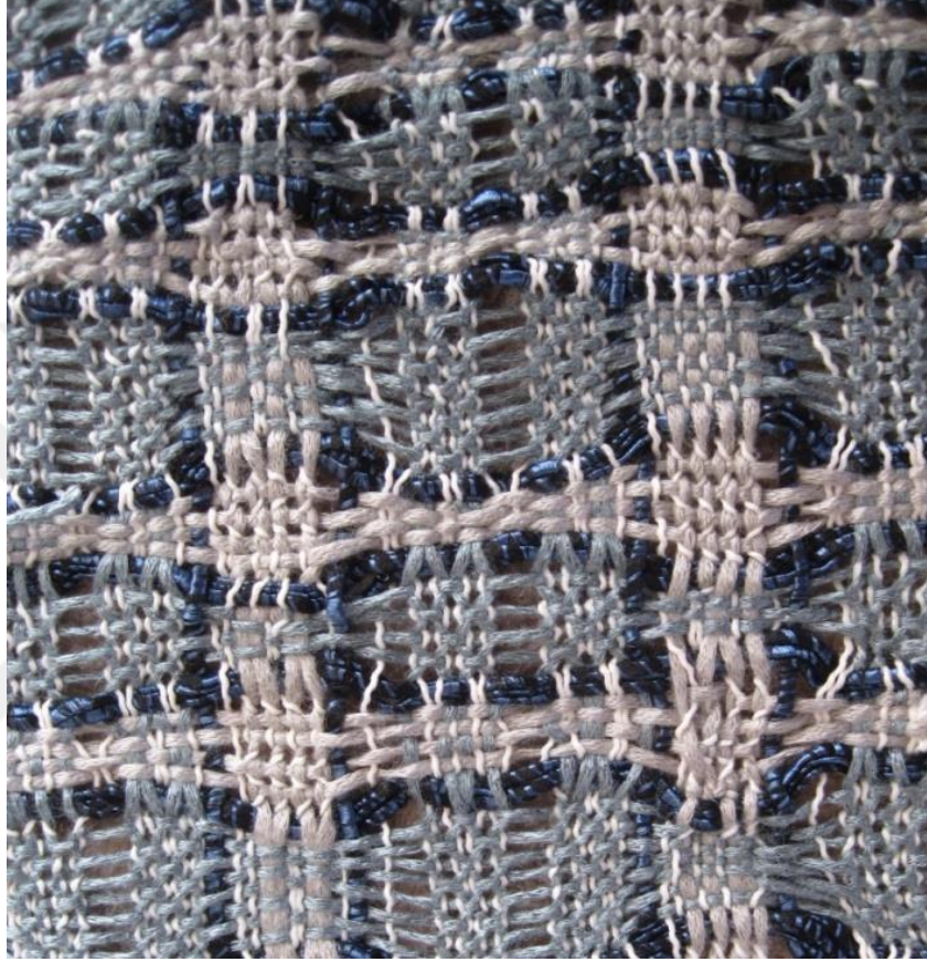
Resim 2.40. İki Döner Gücü Kullanılarak Elde Edilen Ve Zıt Yönde Yapılan Leno Dokuma 18
