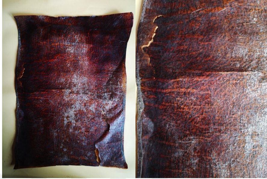
Şekil 4.10: Kombucha Deney 6- Kombucha Üzerine Pigment Dijital Baskı (Fikseli)
