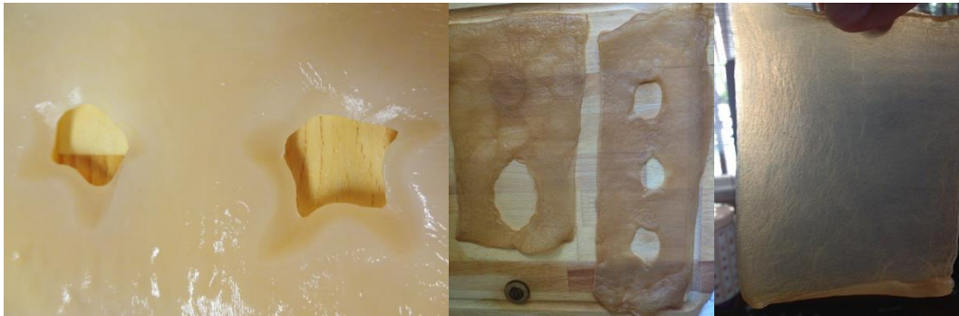
Şekil 4.2: Kombucha Deney1- Kurumadan Önce (soldaki) ve Sonra (ortadaki ve sağdaki) Elde Edilen Transparan Yüzey
