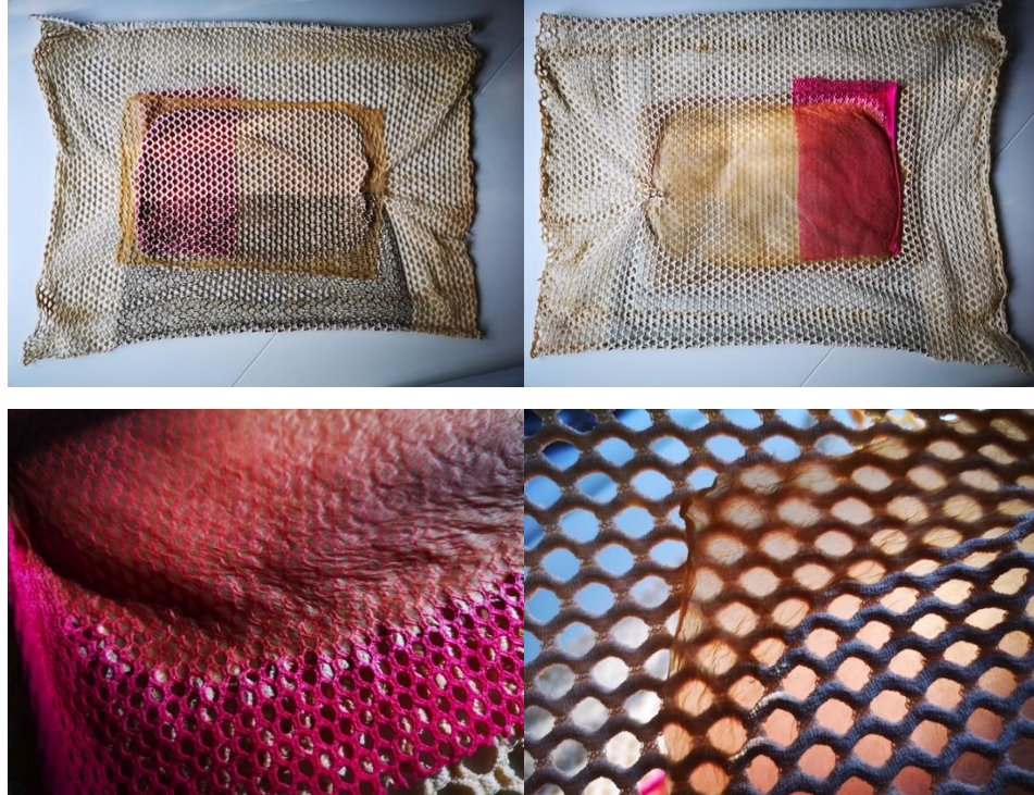
Şekil 4.4: Kombucha Deney 2- Kurumadan Sonra Elde Edilen İki Tekstil Yüzeyini Birleştirmiş Kombucha
