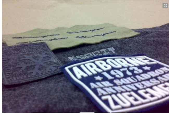
Şekil 3.24: Enjeksiyon Baskı Yöntemiyle Elde Edilmiş Üç Boyutlu Yazı Karakterleri
