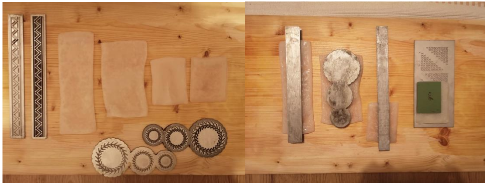
Şekil 4.7: Kombucha Deney 4- Gofraj Kalıplarıyla Kombucha Doku Çalışması
