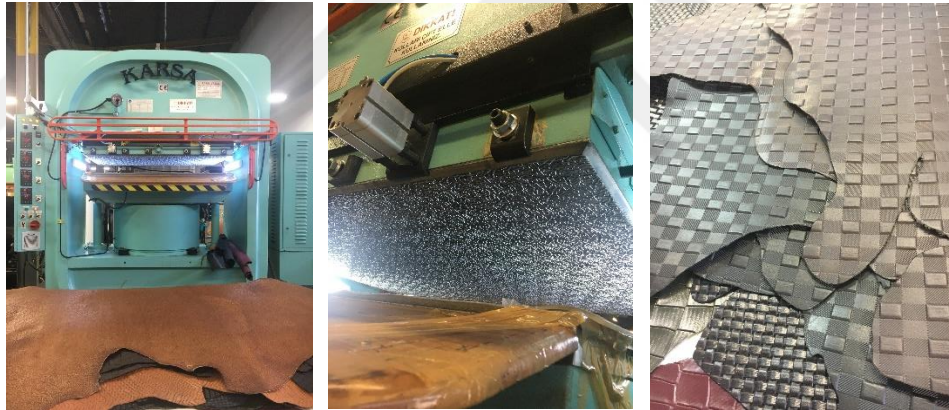
Resim 17: Hidrolik pres makinesinde sıcak plaka ile yapılan baskı uygulamalarında çantalık ve ayakcabılık deriler için daha yüksek basınçlı makinalar kullanılmaktadır 55 .
