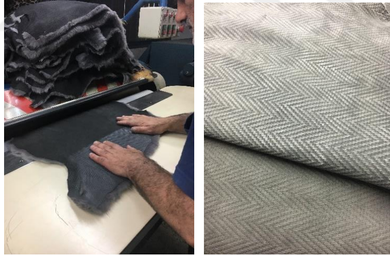
Resim 16: Plaka ile yapılan sıcak baskı sonrasında talebe göre deri tıraş makinesinden geçirilerek deriye daha doğal bir görünüm veriliyor 54 .
