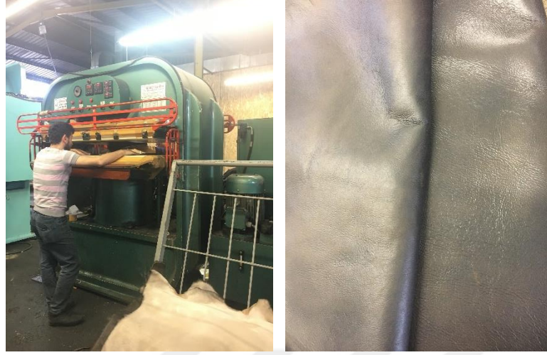
Resim 11: Deri'ye iki düz plaka arasında basınç ile sürtünme olayının uygulandığı derinin düzleştirilmesi ve ütülenmesi esasına dayalı olan makinedir 47 .
