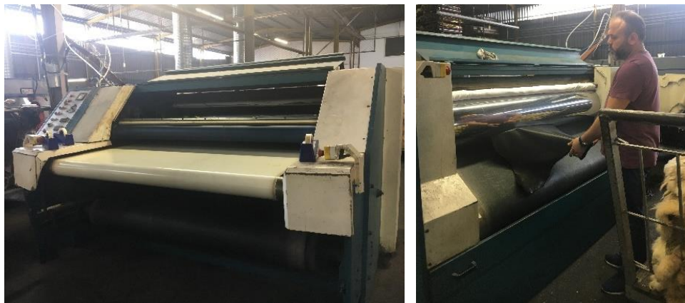
Resim 9: Roto-pres makinesi deri' ye iki düz silindir arasında basınç ile sürtünme olayının uygulandığı, derinin düzgünleştirilmesi ve ütülenmesi ve parlatılması esasına dayalı olan makinedir 44 .
