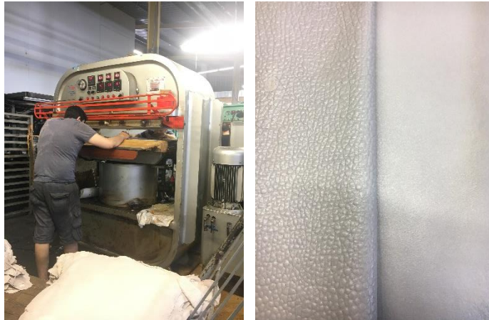
Resim 19: Hidrolik pres makinesinde sıcak plaka ile yapılan baskı uygulaması 57
