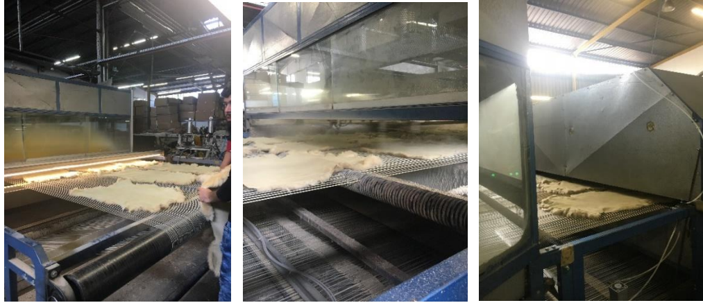
Resim 12: Pistole makinesine derinin yerleştirilme, boyanma ve kuruma aşaması 50 .
