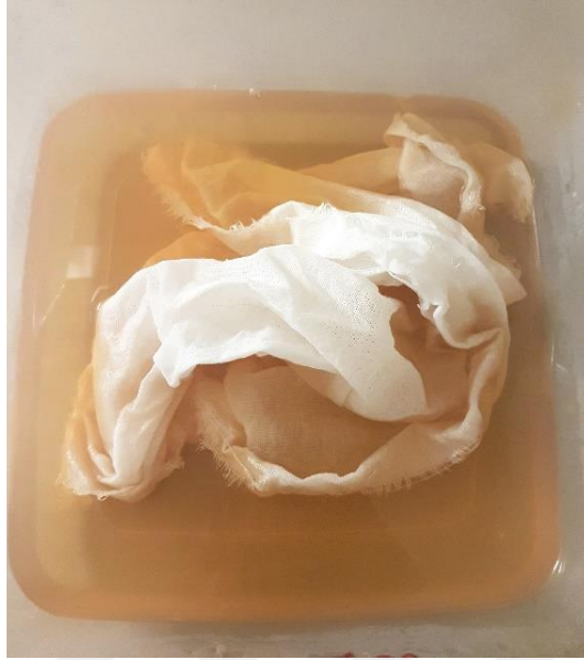
Resim 2.1.2.2 Demir Sülfat Çözeltisine Batırılmış Pamuklu Tülbent Kumaşı (Demir Battaniye)
