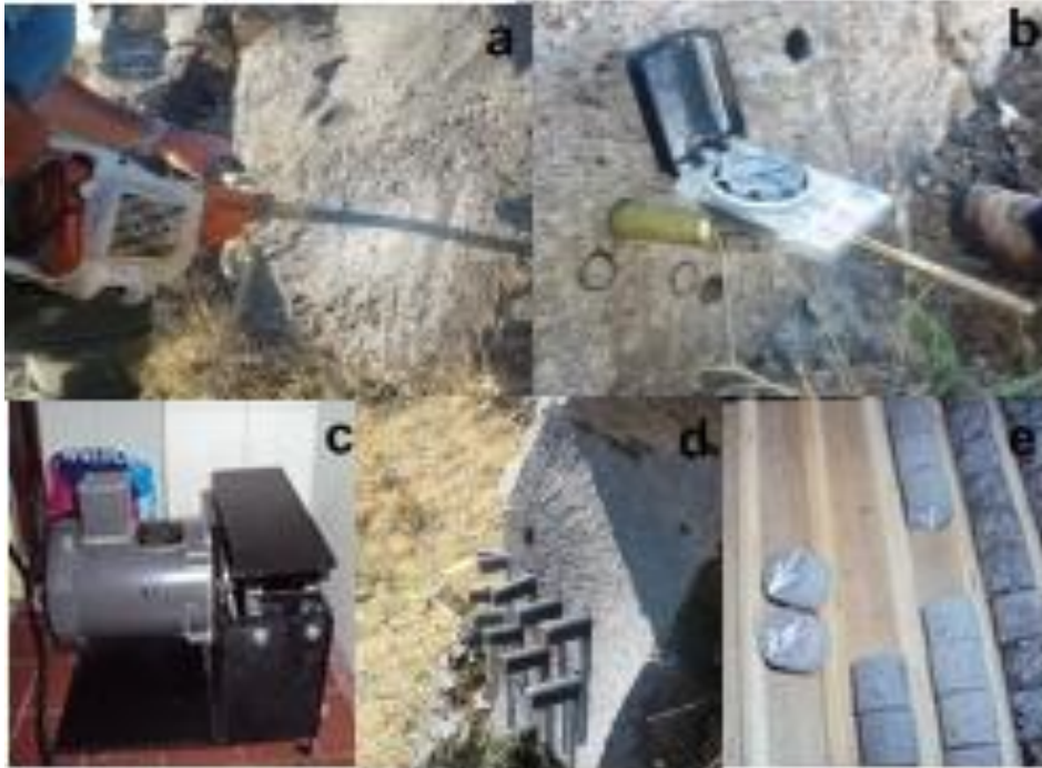
Şekil 3.5: a) Portatif karot alma makinesi b) Pusula ve yönlendirme sehпасı c) Taş kesme cihazı d) Alınan örnekler e) Ölçüme hazırlanan örnekler.
