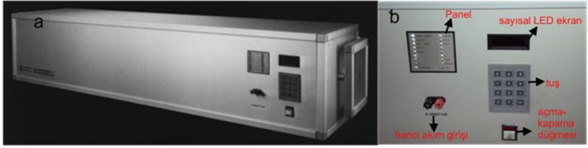
Şekil 3.27: a) MMTD80 ısısal temizleme fırını b) Fırın ölçüm programlamanın yapıldığı ön panelin yakından görüntüsü.
