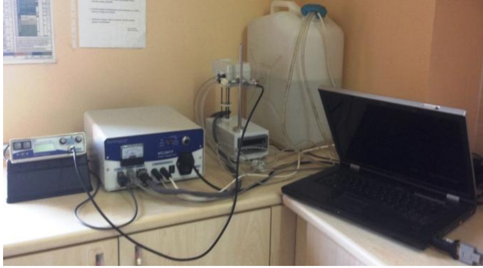
Şekil 3.29: Manyetik süseptibilite-sıcaklık ölçümleri için kullanılan Bartington MS2 Sistemi.
