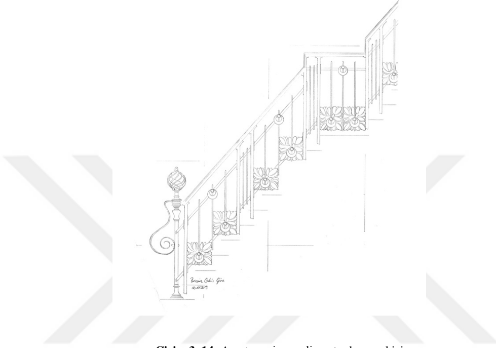
Çizim 3. 14: Apartman iç merdiven trabzan eskizi
