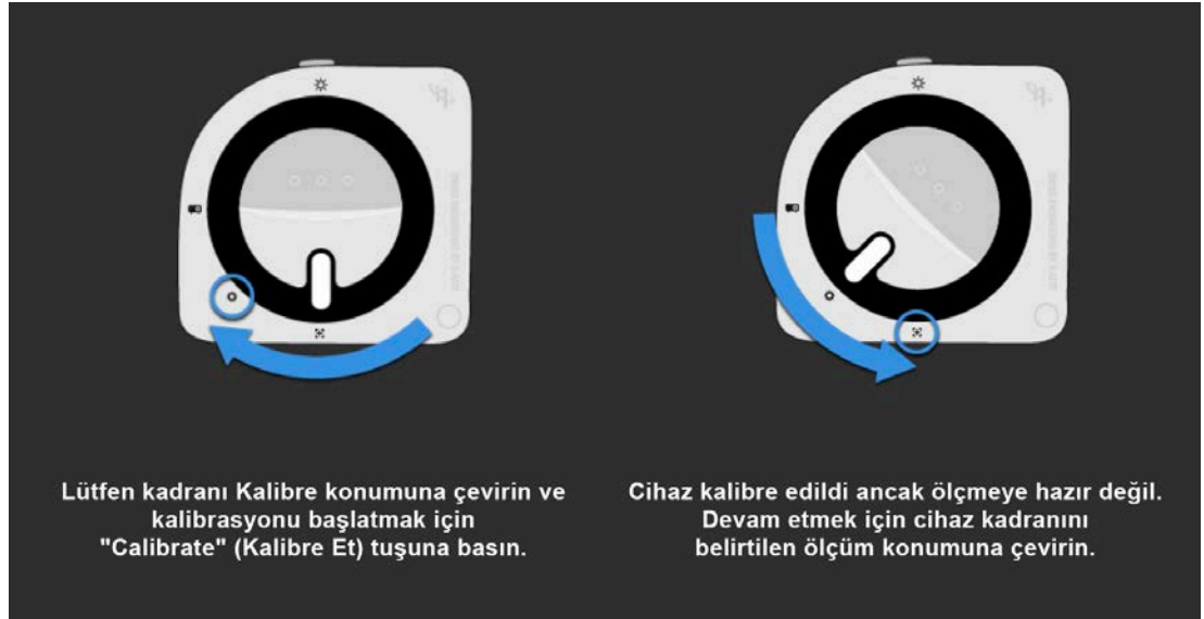
Şekil 6.35 Cihazın kendi içinde kalibrasyonu (iStudio Yazılımının Ekran Fotoğrafı)
