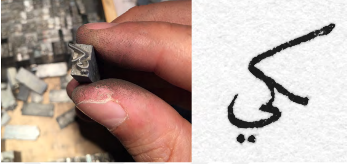
Şekil 1. 9 Solda: 24 punto kurşun alaşımıyla dökülmüş Nesih harufatı. Tek bir nevi üstünde kef (ك) ve ye (ي) harflerinin bitişmiş şeklinin kabartma halindeki üst yüzey görüntüsü. Sağda: bu nevinin baskı sonrasında elde ettiği yazı karakterinin sureti. (Fotoğraf ve Baskı: Onur Yazıcıgil Arşivi, İstanbul, 2017)
