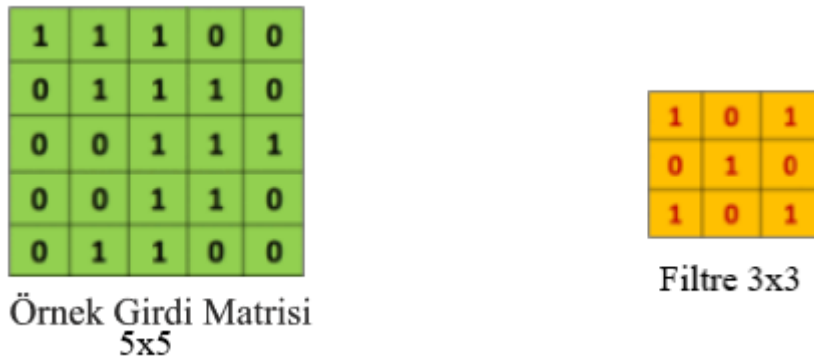
Şekil 2.14: Konvolüsyon katmanı girdi ve filtre matrisleri örneği [28]
