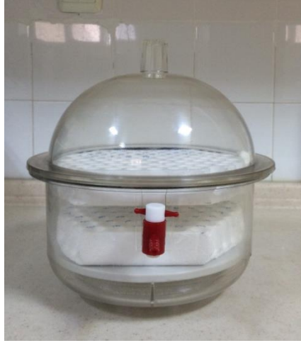
Şekil 9. Su Emilimi ve suda çözünürlük ölçümleri için kullanılan desikatör
