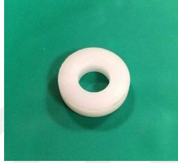
Şekil 6. Kompozit rezin disklerin hazırlanmasında kullanılan teflon kalıp
