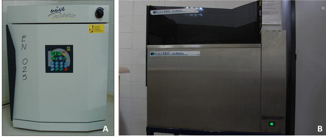
Şekil 3.2.5. A. Etüv cihazı B. Termal devalendirme cihazı
