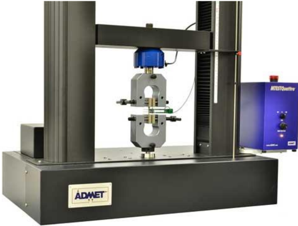
Şekil 1.8. Mikrotensile testi için kurulan düzenek (ADMET, Norwood, Amerika)
