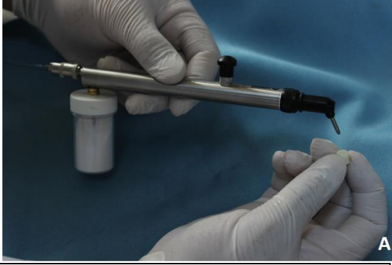
Şekil 3.2.4.1A Alt yapının Al 2 O 3 ile kumlanması
