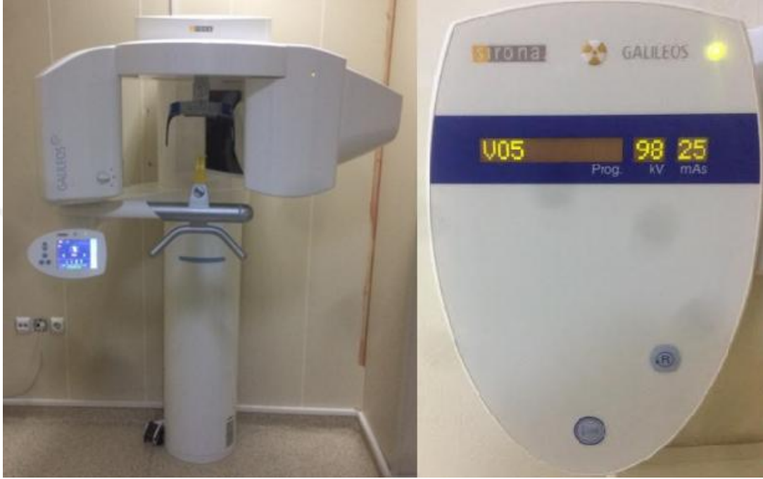
Şekil 30. Çalışmada kullanılan KIBT cihazı (GALILEOS Comfort Plus, Sirona Dental Systems, Bensheim, Germany)
