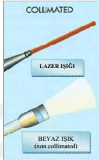
Şekil 5: Lazer ışığının collimated özelliği.
