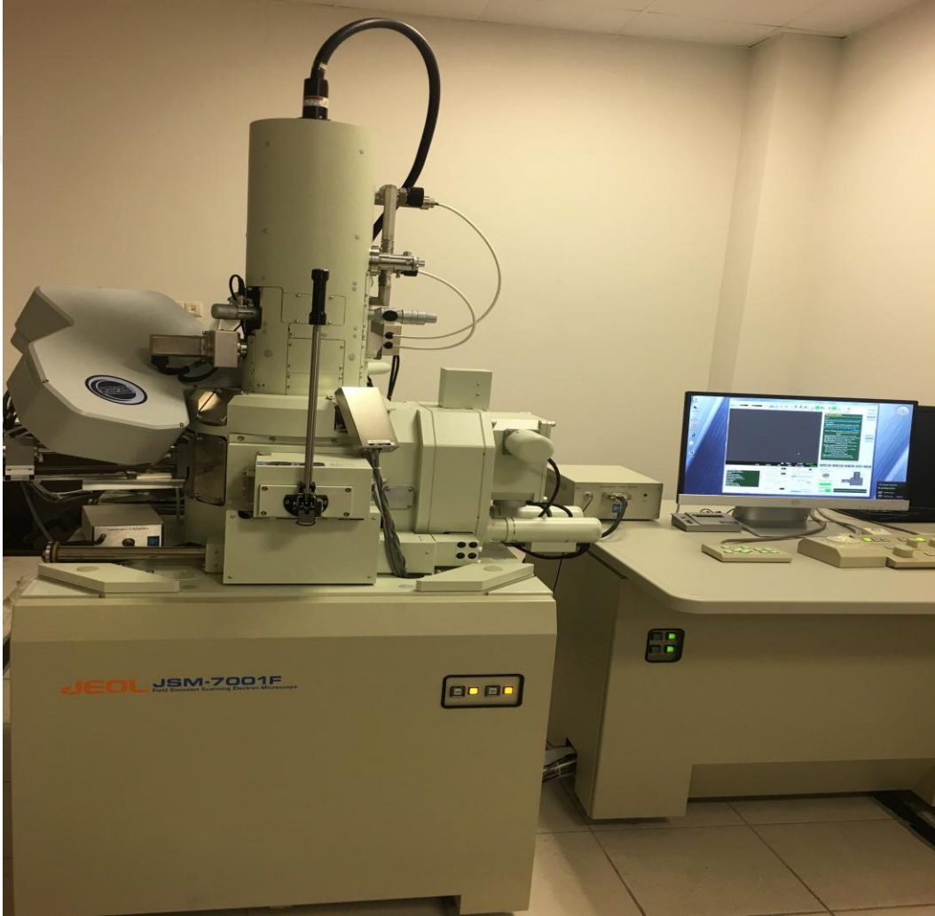
Şekil 19. Çalışmamızda kullandığımız SEM cihazı
