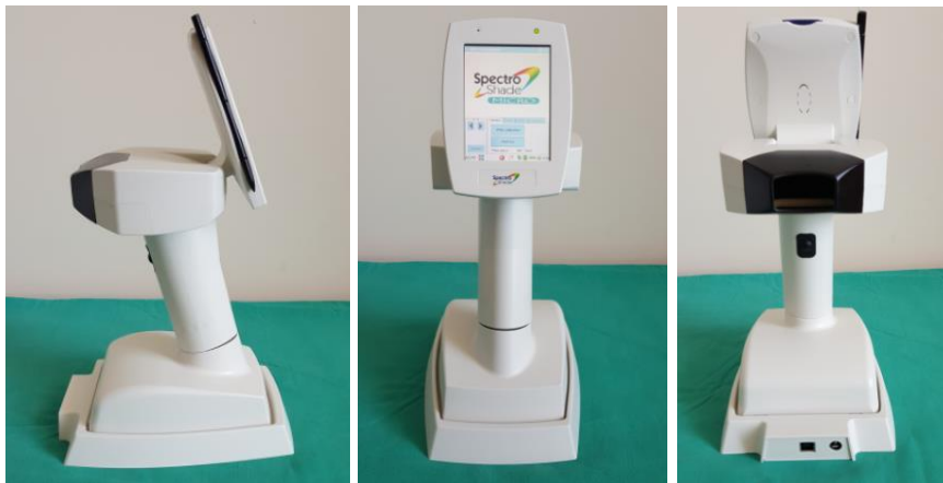
Şekil 14. Örneklerin renk ölçümlerinde kullanılan spektrofotometre cihazı
