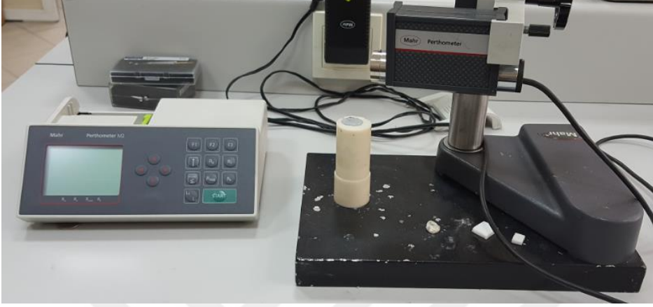
Şekil 12.Örneklerin yüzey pürüzlülüklerini ölçmek için kullanılan profilometre cihazı
