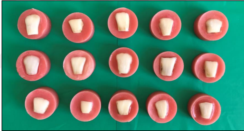
Şekil 7: Örneklerin akrilik bloklara gömülmesi
