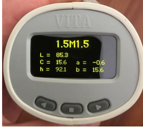
Şekil 26. Easyshade Compact Cihazı ile Renk Ölçümü ve L, a, b Değerlerinin Tespiti
