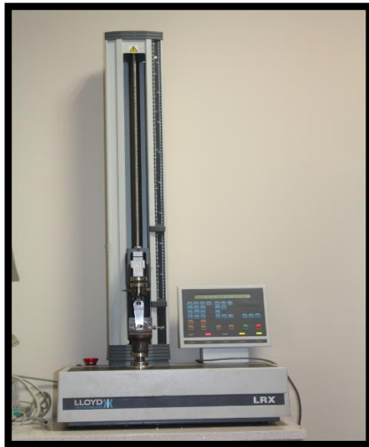
Şekil 13. Makaslama bağlanma değerlerini ölçmek için kullanılan test cihazı
