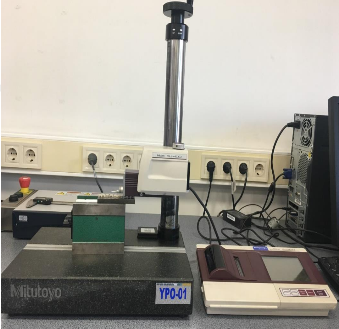
Şekil 14. Örneklerin yüzey profilometresi ile yüzey pürüzlülüklerinin ölçülmesi
