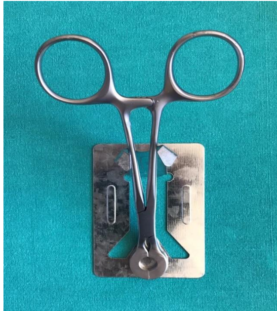
Şekil 9. Kompozit rezin disklerin hazırlanmasında kullanılan paslanmaz çelik kalıp
