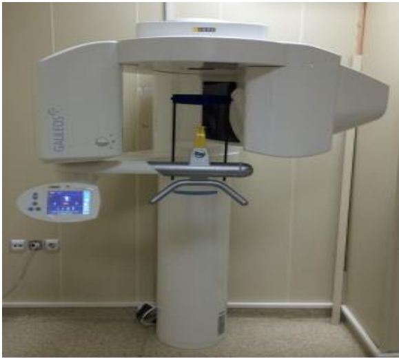
Şekil 9: Çalışmada kullanılan KIBT cihazı
