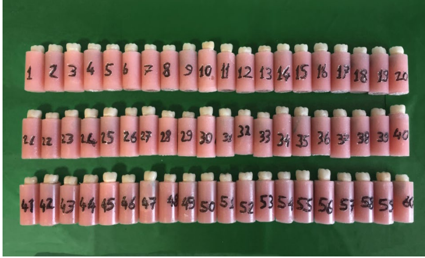
Şekil 3.16. Örneklerin kırılma testi için akrilik rezin bloklara gömülmesi
