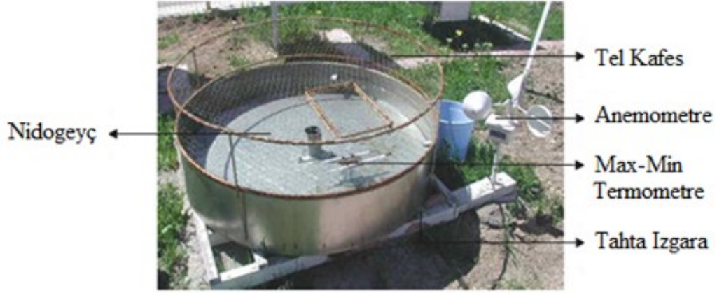
Şekil 3.4. A Sınıfı Buharlaşma Tavasası
