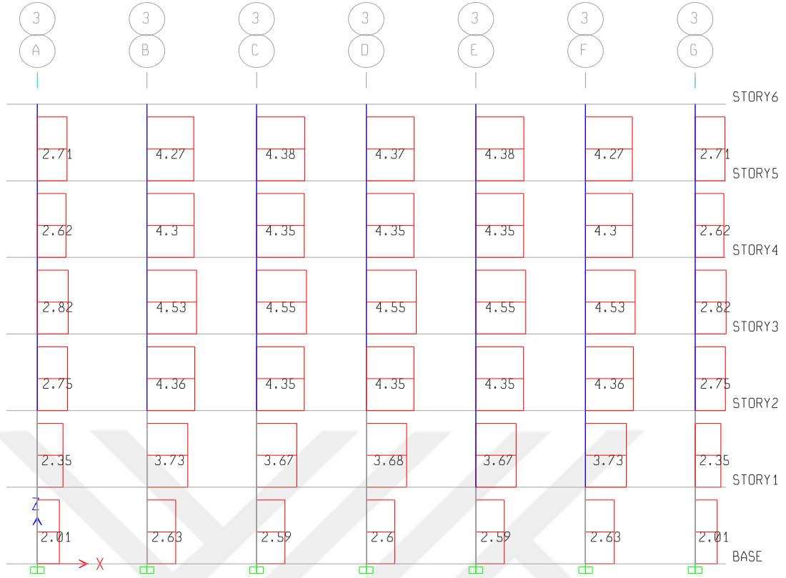
Şekil 4.110. WB-W modeli 3. aks Ex kesme kuvvetleri (birim x 10 kN)
