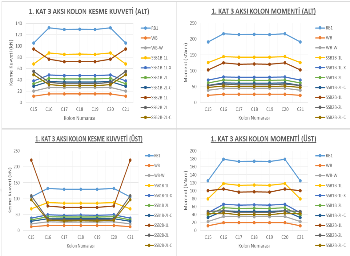
Şekil 5.7. 1. kat 3 aksı kolon alt ve üst noktaları moment ve kesme kuvveti karşılaştırması
