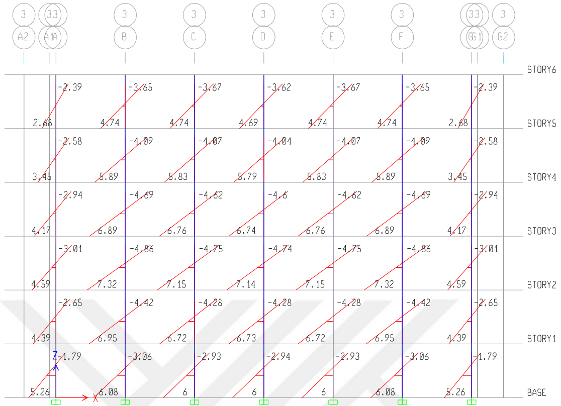
Şekil 4.210. SSB1B-2L-C binası 3. aks Ex momentleri (birim x 10 kNm)
