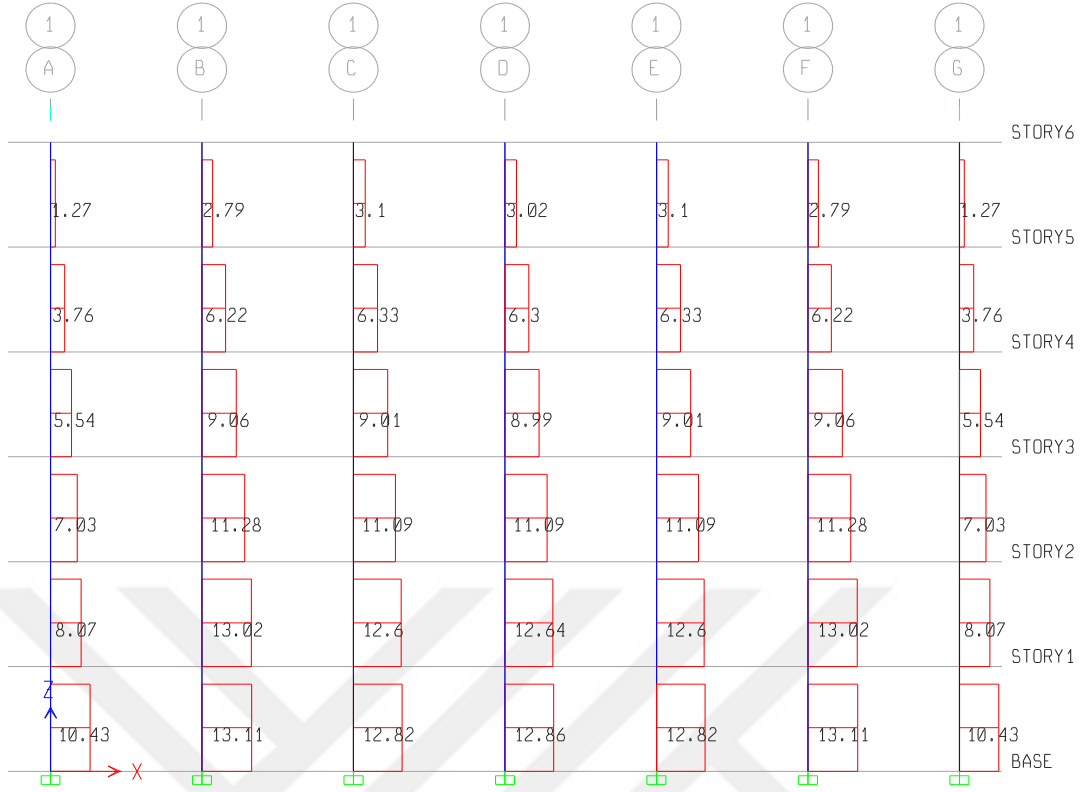
Şekil 4.59. RB1 binası 1. aks Ex kesme kuvvetleri (birim x 10 kN)
