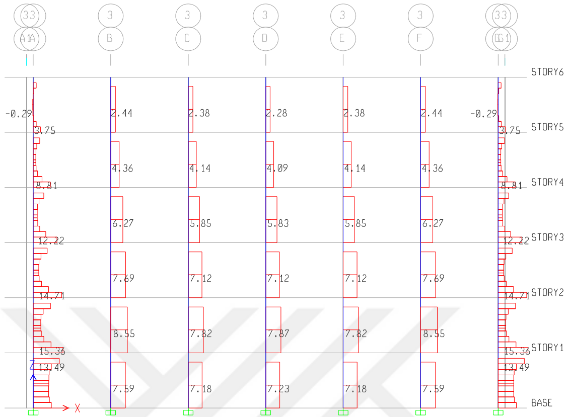
Şekil 4.227. SSB2B-1L binası 3. aks Ex kesme kuvvetleri (birim x 10 kN)
