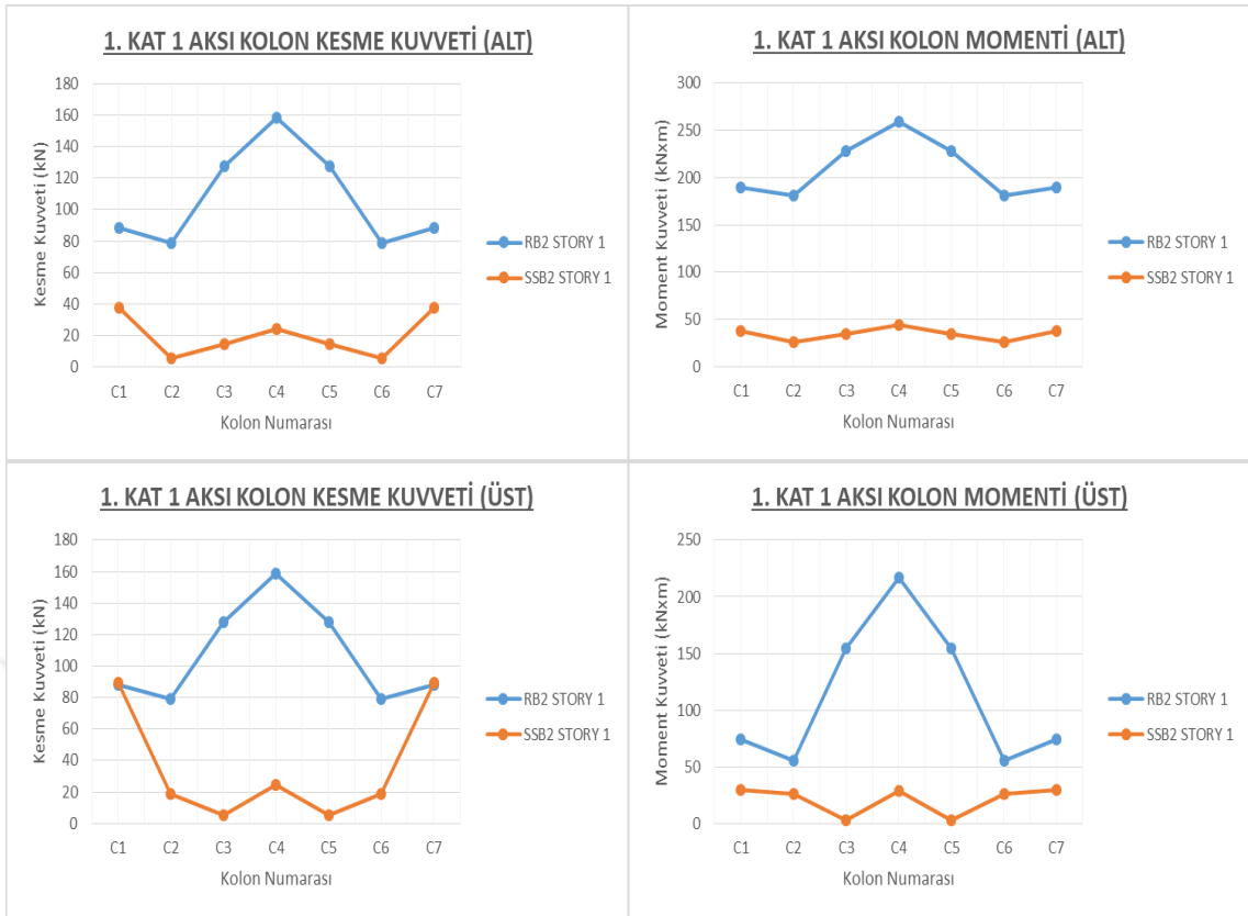
Şekil 5.15. 1. kat 1 aksı kolon alt ve üst noktaları moment ve kesme kuvveti karşılaştırması
