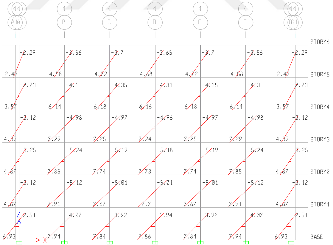
Şekil 4.159. SSB1B-1L-X binası 4. aks Ex momentleri (birim x 10 kNm)
