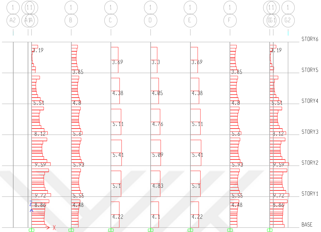
Şekil 4.173. SSB1B-2L binası 1. aks Ex kesme kuvvetleri (birim x 10 kN)
