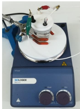
Şekil 3.1. Elektrokimyasal ölçümlerin yapıldığı hücre
