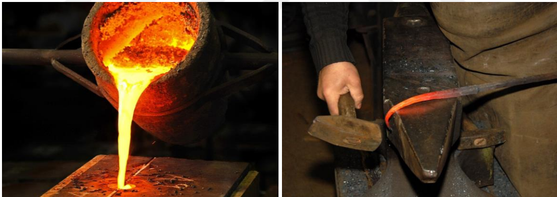
Şekil.3.6.a ve 3.6.b. Dökme demir ve dövme demirin üretimi (URL-9, 2019)
