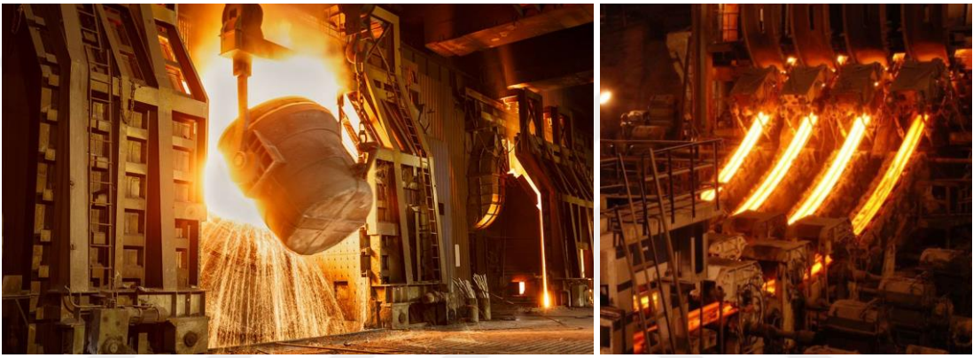
Şekil.3.7.a ve 3.7.b. Bazik oksijen fırınında çelik üretimi (URL-12, 2019) ve sürekli döküm yöntemi (URL-13, 2018)
