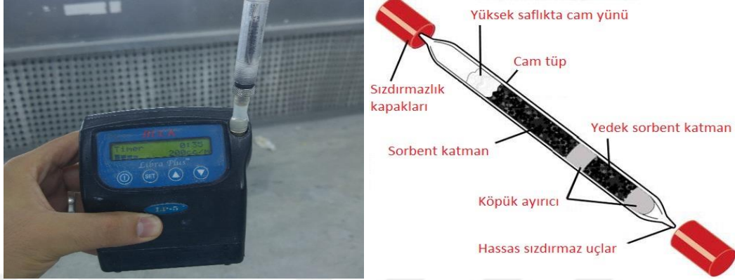
Şekil 4 Buck Libra Plus LP-1 Atmosferik Gaz Örneklemesi cihazı ve Aktif Karbon Tüpü
