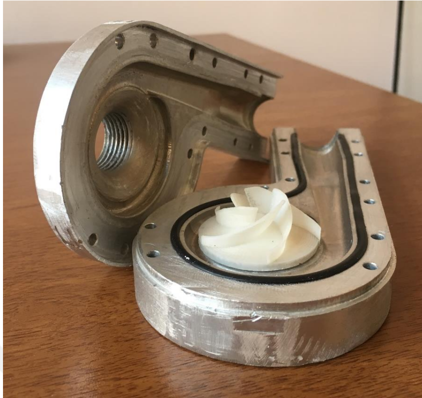
Şekil 3.6. Alüminyum malzemeden üretilen salyangoz gövdesi
