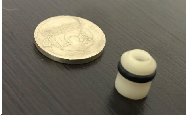
Şekil 3.10. Pompa sisteminde kullanılan radyal hidrodinamik yatak
