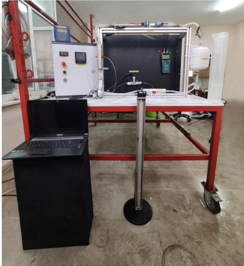
Şekil 3.19. Kan pompası deney düzeneği
