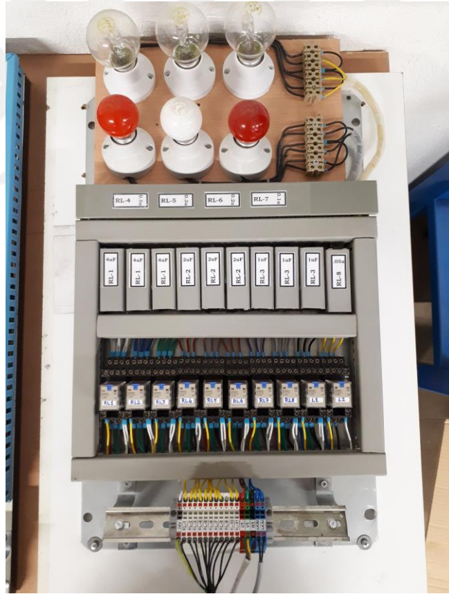
Şekil 5.16. Kondansatör ve anahtarlama rölelerinin sistemdeki yeri
