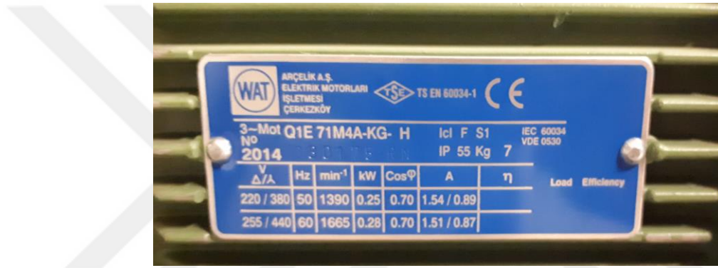
Şekil 5.15. KUAJ için kullanılan asenkron jeneratörün etiket bilgileri
