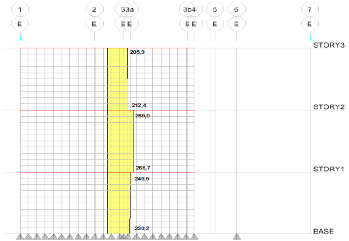
Şekil 4.83. D25 duvarların kesme kuvvetlerin dağılımı
