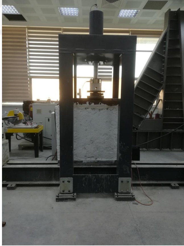
Şekil ek 1. 4. Yığma duvar numunesi üstünde düşey yükleme deney düzeneği
