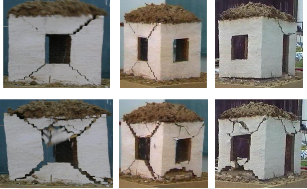
Şekil 2.4. Yığma bina sarsma deneyi hasar durumu (Korkmaz, 2007)
