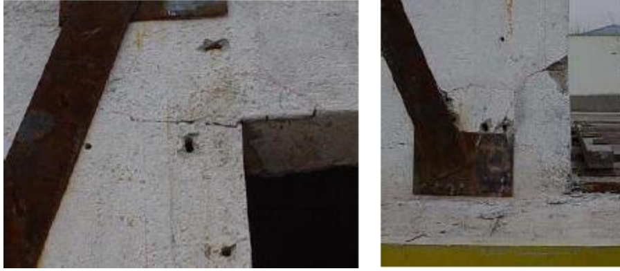
Şekil 2.11. deneylerin sonunda gelişen çatlaklar (Altın ve ark., 2005)
