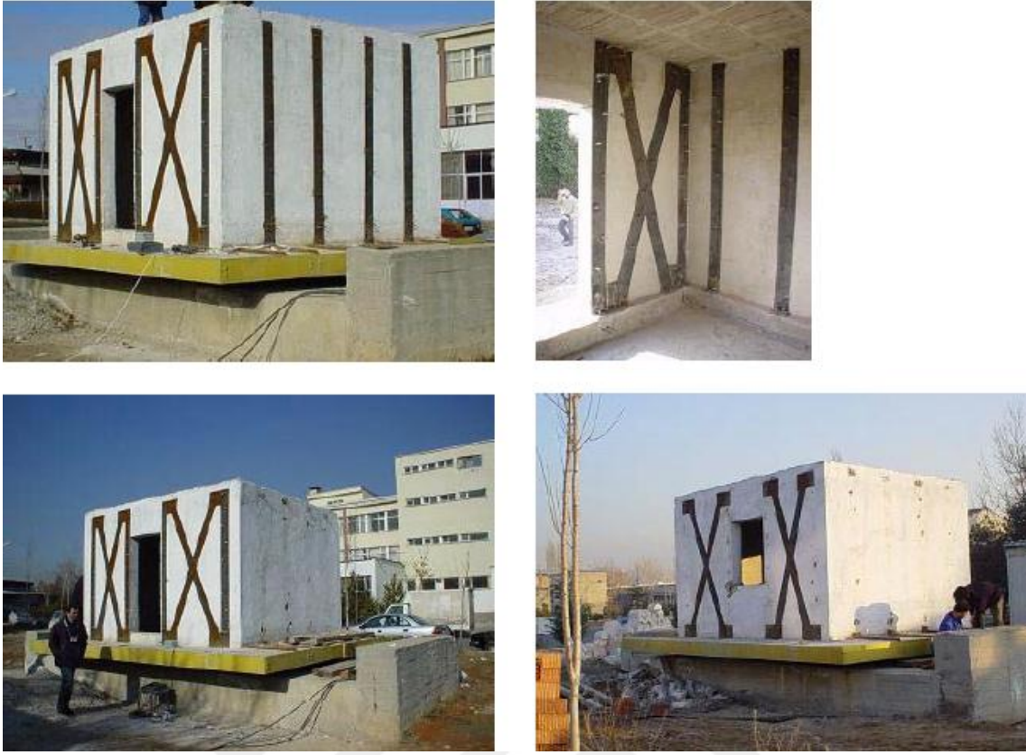
Şekil 2.9. Çelik şerit düzenlemeleri (Altın ve ark., 2005)
