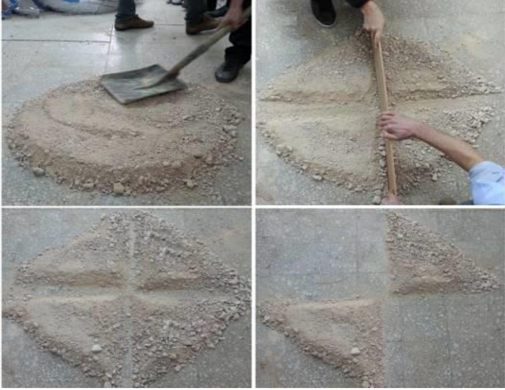
Şekil 4.9. Oluşturulan diskin dört parçaya bölünmesi
