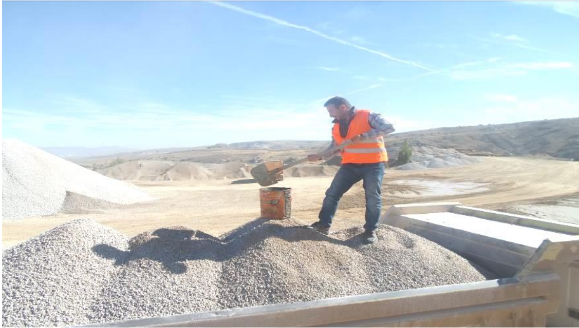
Şekil 4.5. Mamak-Eski Kıbrıs Kırmataş Ocağından 5-13 mm agrega numunesinin kamyon üzerinden alınması
