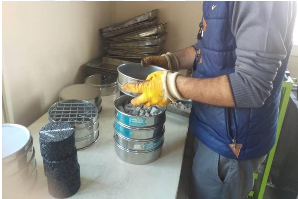
Şekil 4.14. Los Angeles deneyi için A sınıfı gradasyon elemesi
