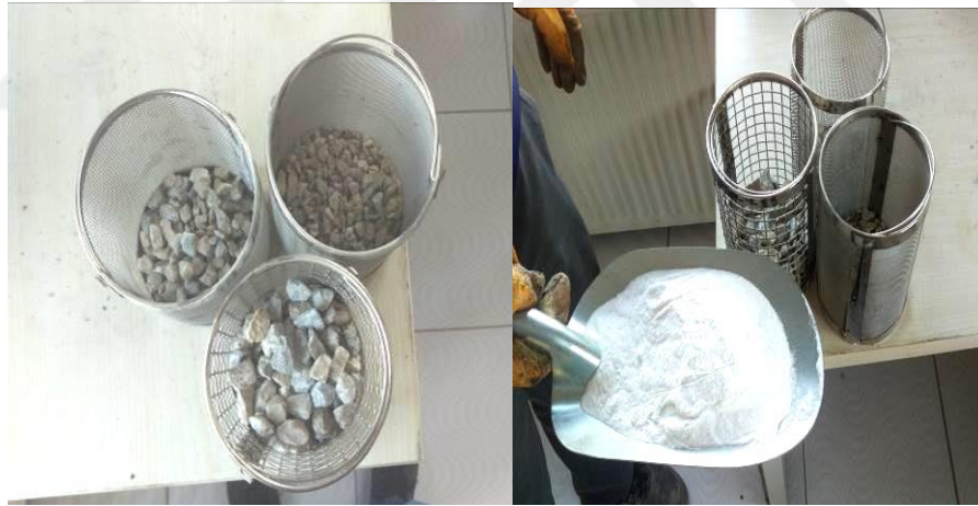
Şekil 4.15. Kullanılan tel sepetler ve Magnezyum sülfat tozu
