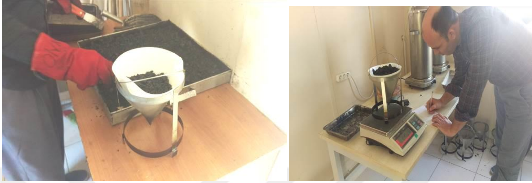
Şekil 4.31. Bitüm karışımının tel sepete konulup tartılması
