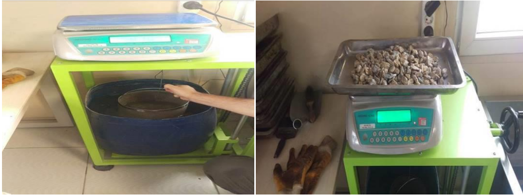
Şekil 4.19. Doygun numunelerin havada ve sudaki ağırlıkları
