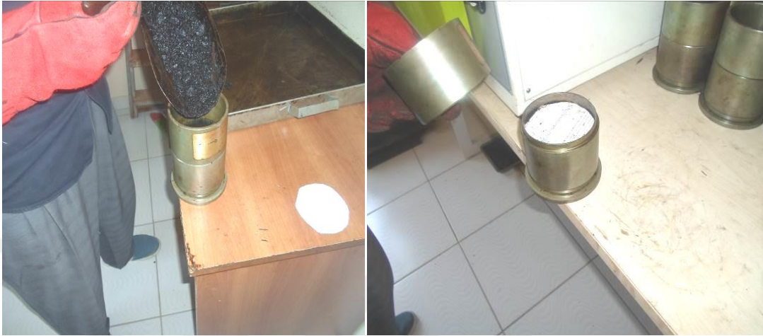
Şekil 4.30. Bitümlü sıcak karışımların briketlere yerleştirilmesi
