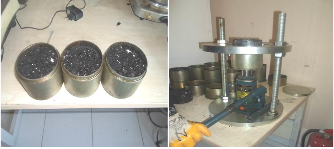
Şekil 4.32. Numunelerin briketlerden çıkarılması
