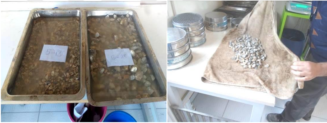
Şekil 4.18 Agregaların suya doygun hale getirilmesi ve yüzey neminin kurulanması
