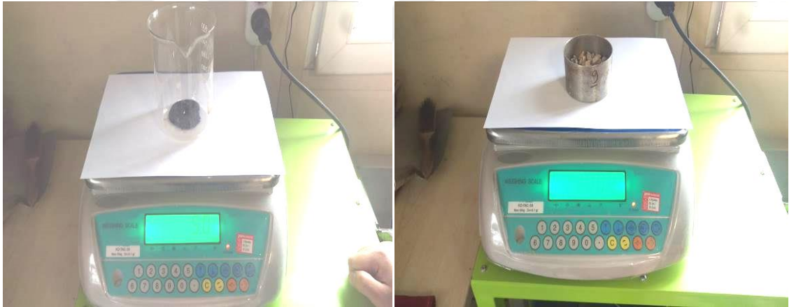
Şekil 4.20. Bitüm ve agreganın tartılması
