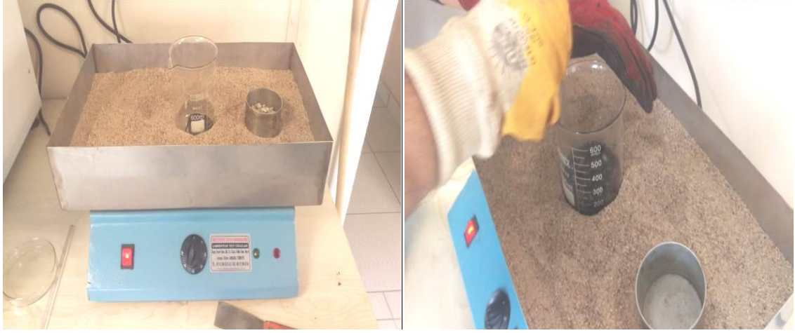
Şekil 4.21a. Agrega ve bitümün kum banyosunda eşit sıcaklıkta karıştırılması
