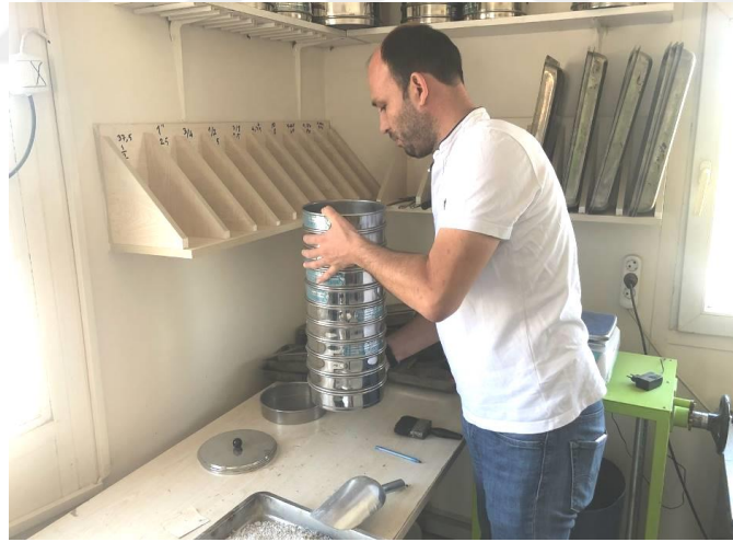
Şekil 4.32. Bitümden ayrılmış agregaların elenmesi
