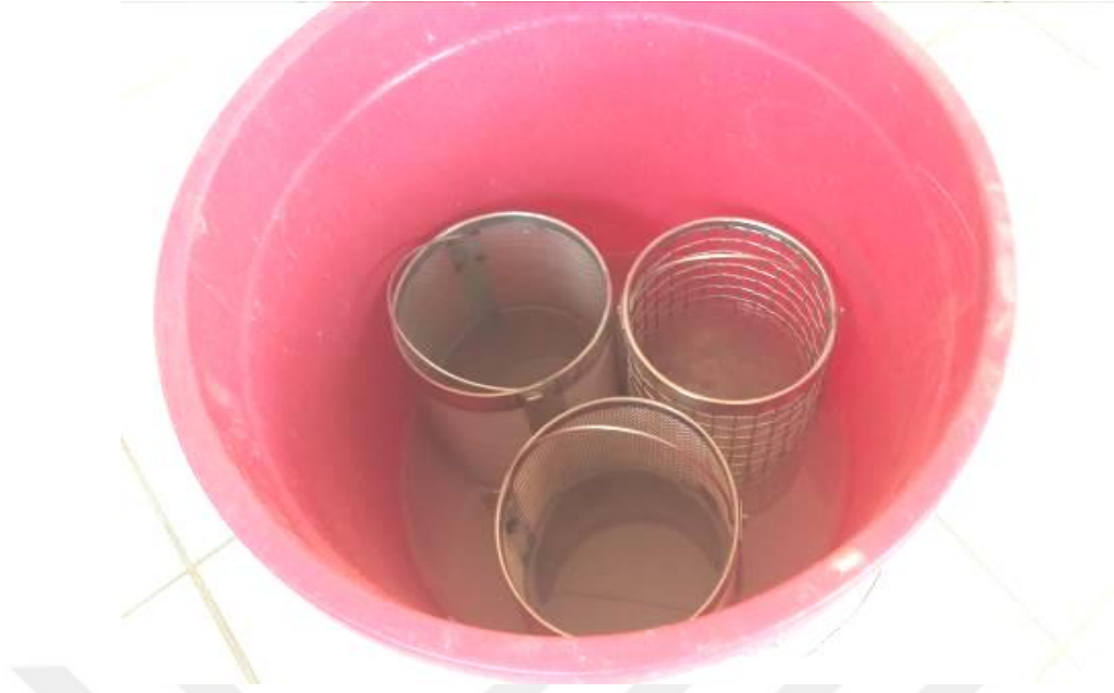
Şekil 4.17. Magnezyum sülfat çözeltisi hazırlanması ve numunelerin bekletilmesi
