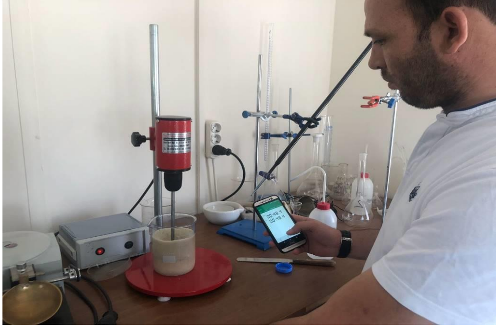
Şekil 4.26. Karışımın 600 devir/dakika hızla 5 dk karıştırılması
