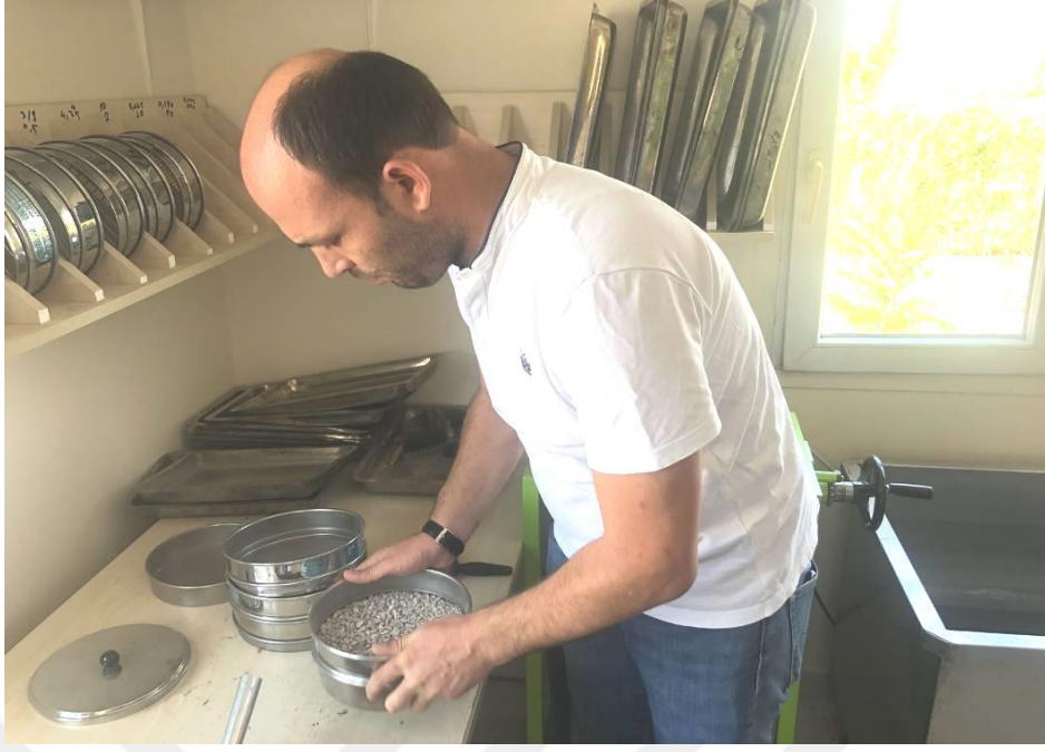
Şekil 4.23 Numunelerin 0-2mm elektenmesi
