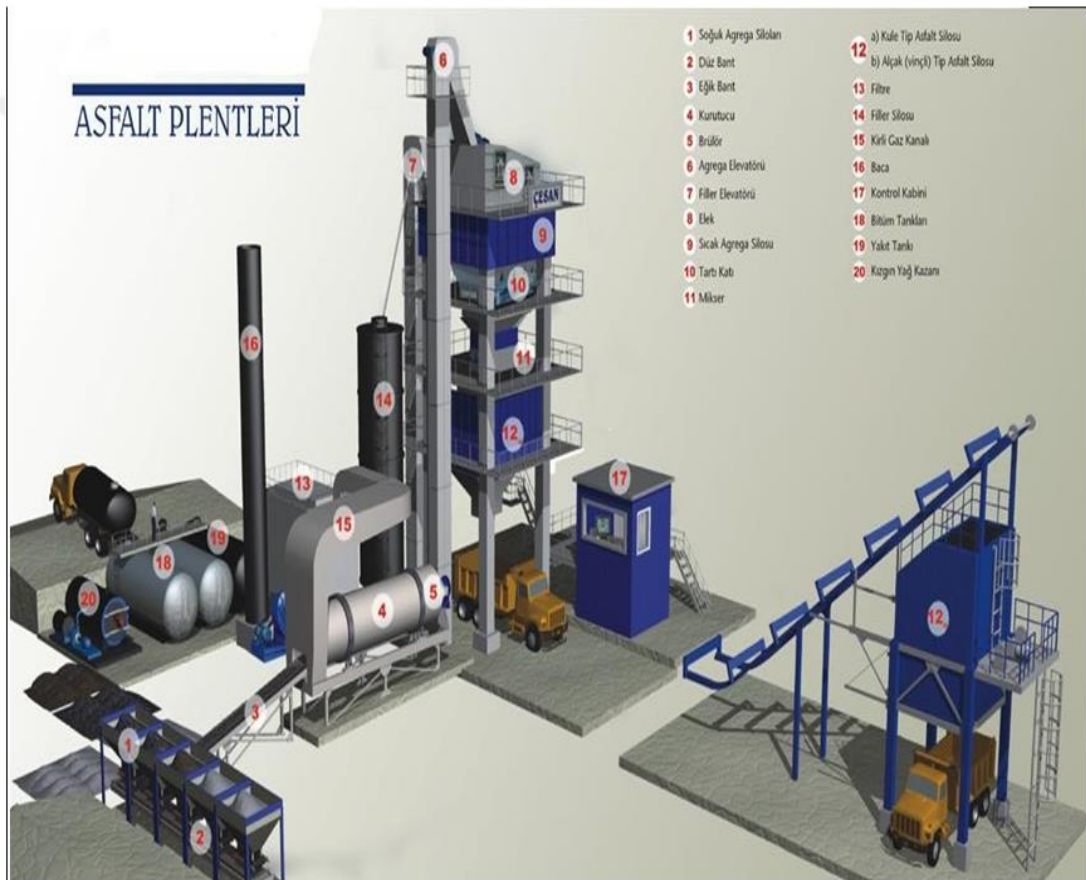
Şekil 2.9. Harman(Batch) tipi asfalt plenti
