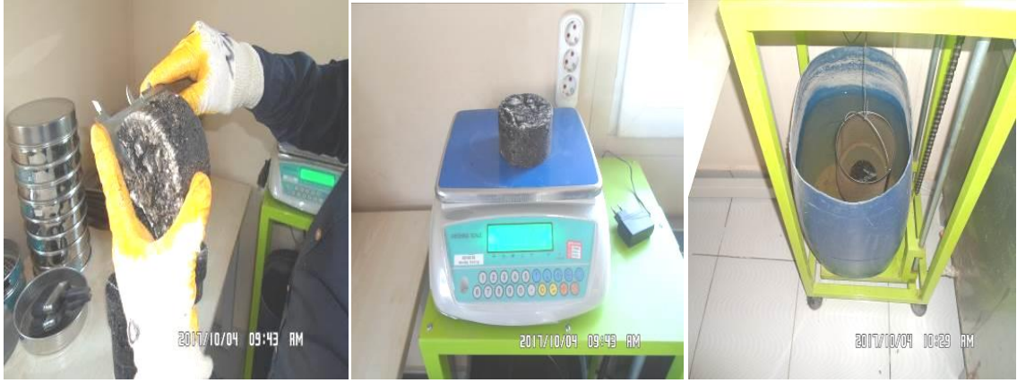
Şekil 4.34. Briketlerin yükseklik ölçümü, havada ve suda tartımları
