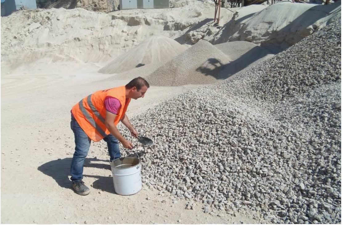
Şekil 4.3. Çayırhan Kırma taş Ocağından 13-25 mm boyutundaki agreganın stok sahasından numune alım işlemi
