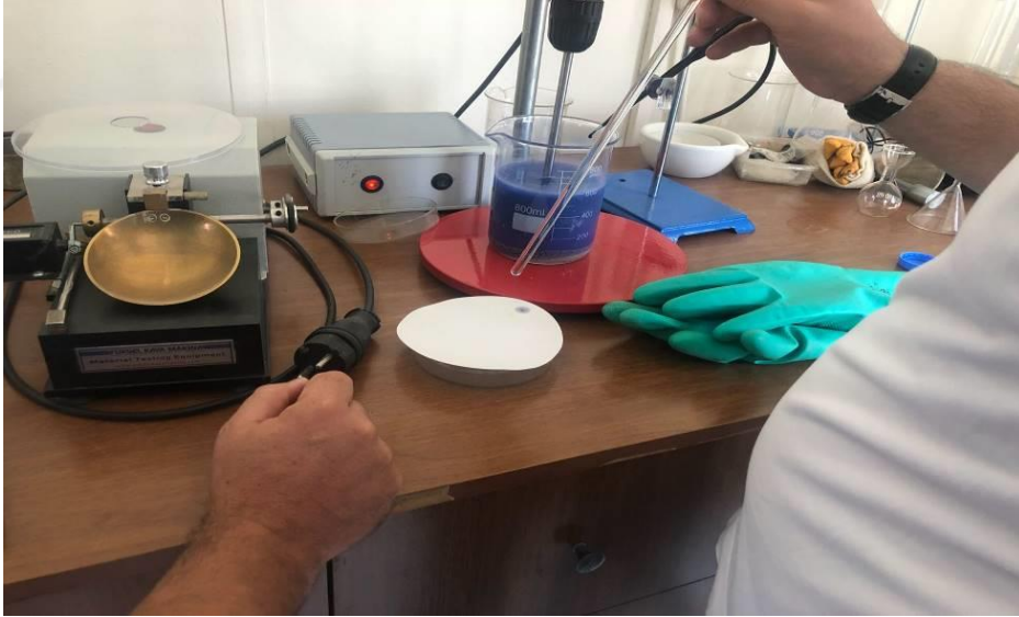
Şekil 4.28. Karışımından alınan damlanın süzgeç kâğıda damlatılması
