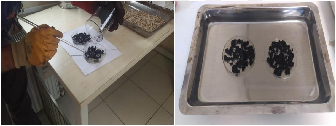
Şekil 4.21b. Karışımların petri kaplara konulması ve su tepsisinde bekletilmesi
