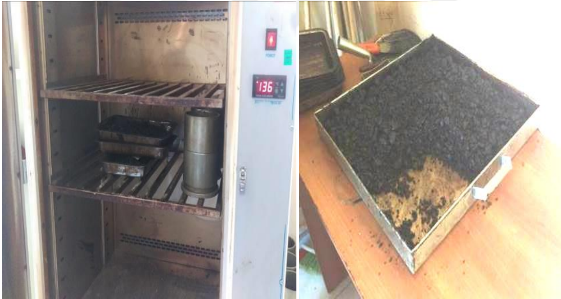
Şekil 4.28. Bitüm sıcak karışımlarının homojen ayrılması ve etüve konulması işlemi
