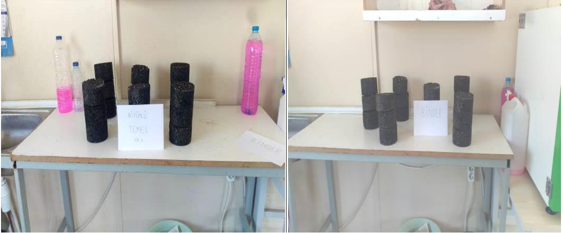
Şekil 4.33. Hazırlanmış bir gece bekletilen briketler
