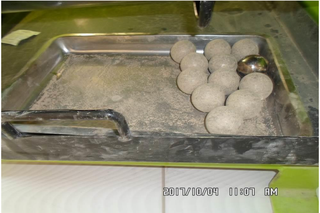
Şekil 4.13. Los Angeles cihazında kullanılan bilyeler
