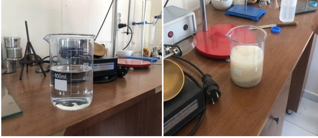
Şekil 4.25. 200 gr numunenin 500 ml saf suya konulması
