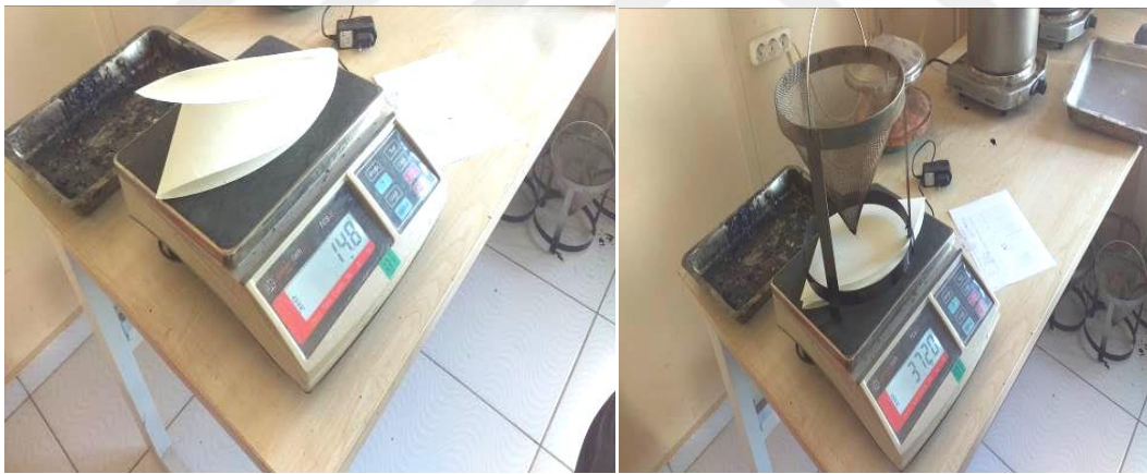
Şekil 4.30. Filtre kağıdının tek başına ve tel sepetle ağırlığı
