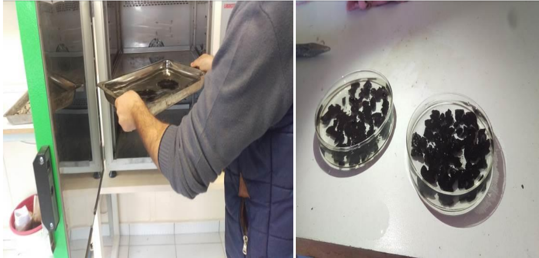
Şekil 4.22. Karışımların etüve atılması ve 24 saat sonra ışık altında gözlemlenmesi
