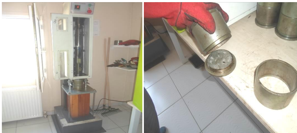
Şekil 4.31. Briketlerinin kalıplarda 75 kere sıkıştırılması ve ters çevrilmesi
