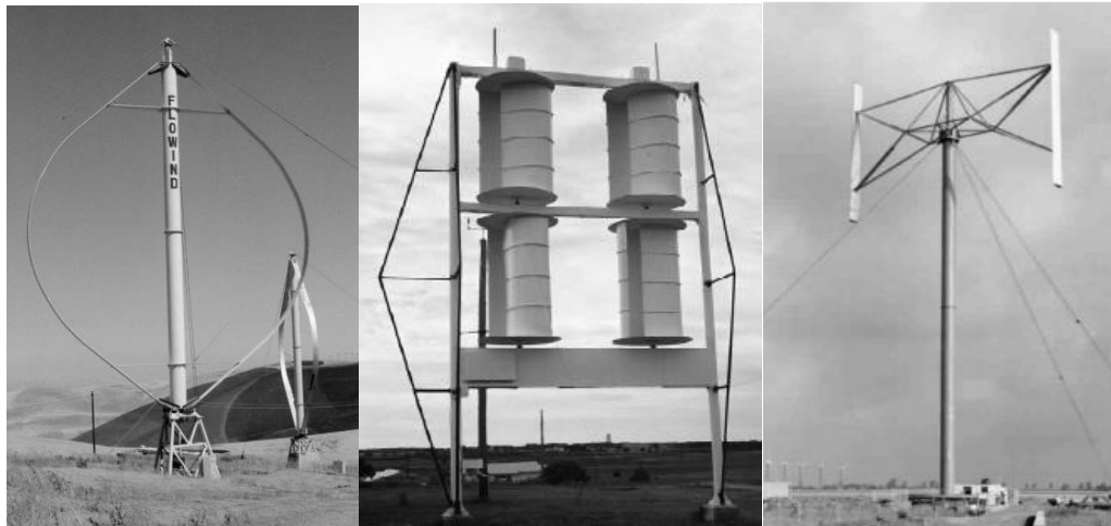
Şekil 1.5. Soldan sağa; Darrieus, Savonius, H-tipi DERT (Hau, 2006; Nelson, 2013)
