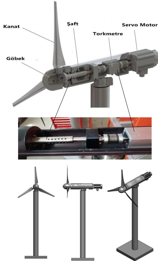
Şekil 6.3. Model rüzgar türbini bileşenleri ve resimleri (Abdulrahim, 2014; Ostovan, 2017)
