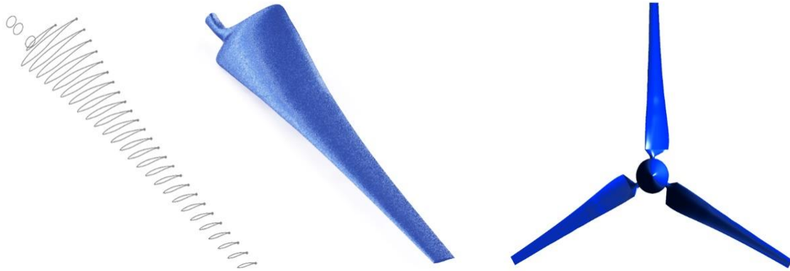
Şekil 4.14. NTNU model rüzgar türbini kanatlarının 3-Boyutlu çizimi
