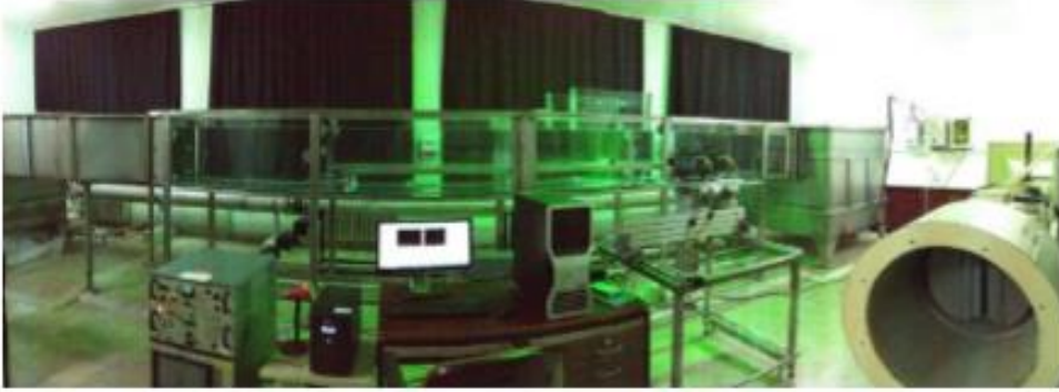
Şekil 3.2. PIV deney düzeneği (Yağmur 2016)
