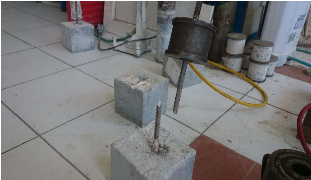
Şekil 4.8. N karışım kodlu betona ait çekme çıkarma deney sonucu
