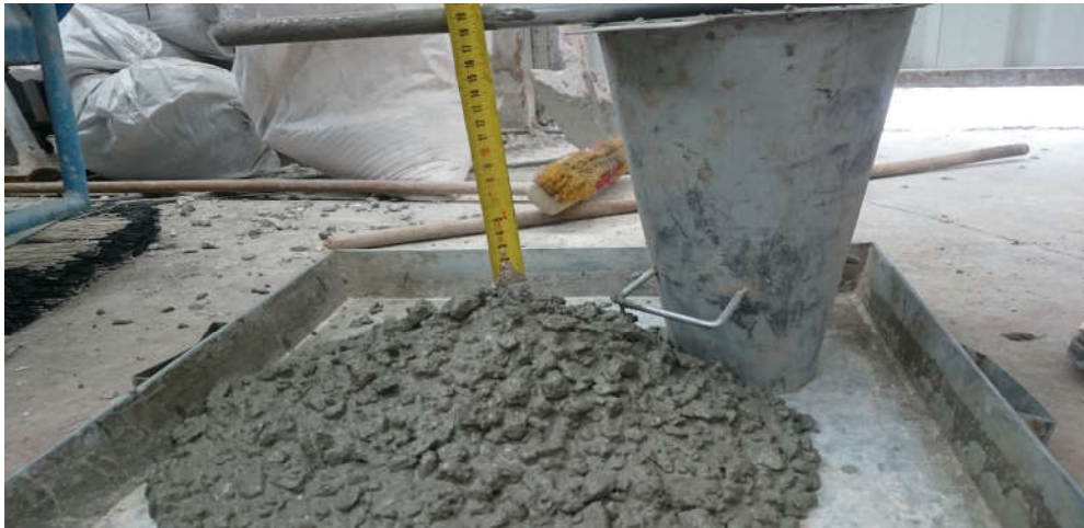
Şekil 3.14. Çökme miktarının ölçülmesi
