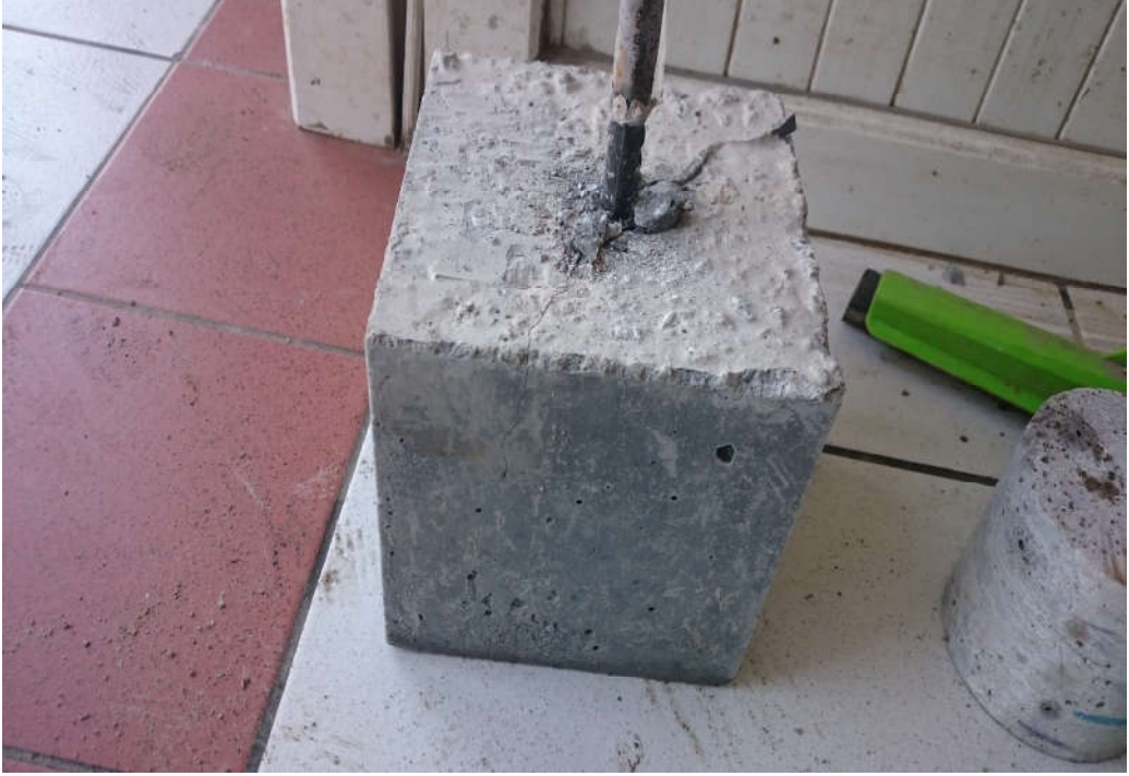
Şekil 4.10. RT karışım kodlu betona ait çekme çıkarma deney sonucu
