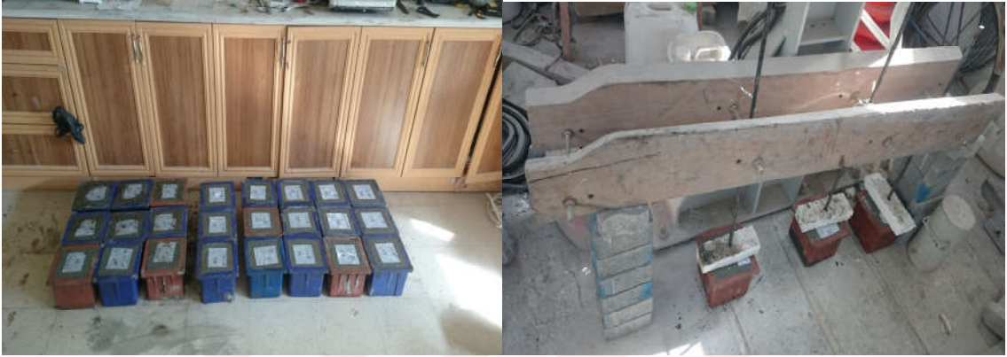
Şekil 3.15. Beton basınç dayanımı ve çekme çıkarma deneyleri için hazırlanan numuneler
