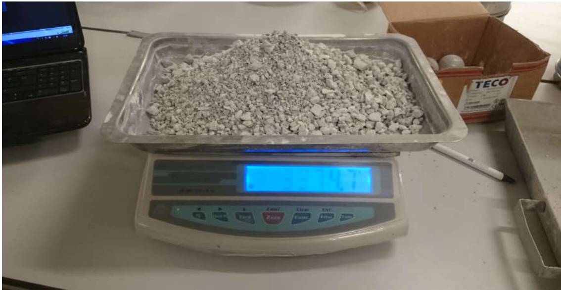
Şekil 3.12. Los Angeles deneyine tabi tutulan numunelerin tartılması
