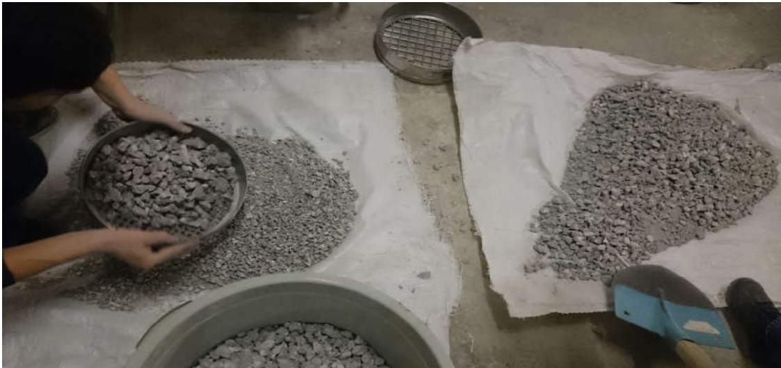
Şekil 3.2. Geri dönüşüm agregaların elekler yardımı ile gruplara ayrılması
