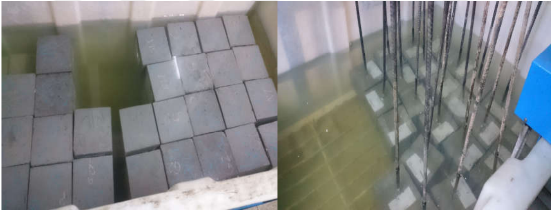
Şekil 3.16. Hazırlanan numunelerin havuzlara kür edilmesi
