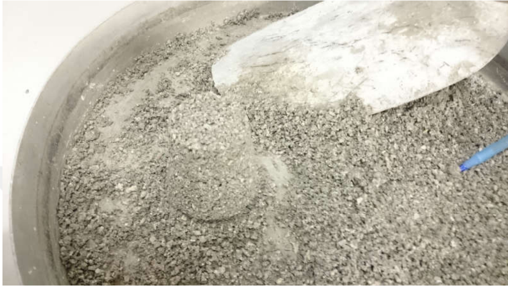
Şekil 3.9. İnce agregalarda kuru yüzey doygun durumunun koni kalıp yardımı ile tespit edilme aşaması
