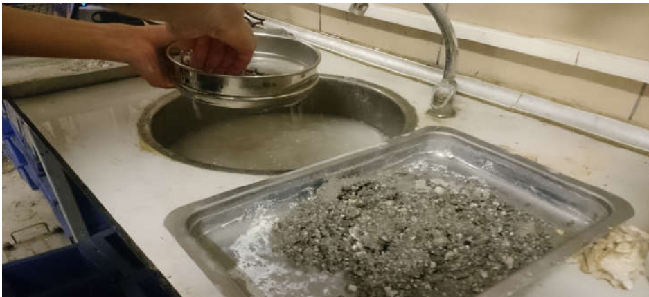
Şekil 3.5. Agregaya numunesinin ele analiz deneyi için 0,063 mm elek ile yıkanması
