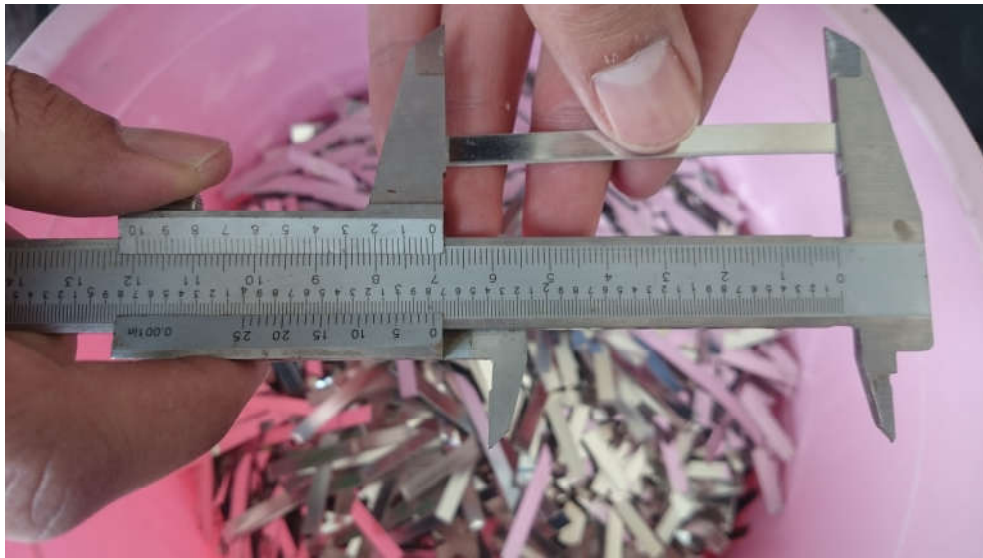
Şekil 3.4. Atık teneke ambalajlarının 70 / 5 mm olarak kesilmiş hali
