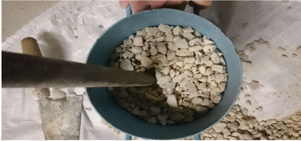
Şekil 3.7. Sıkışık birim hacim ağırlık deneyin yapılışı
