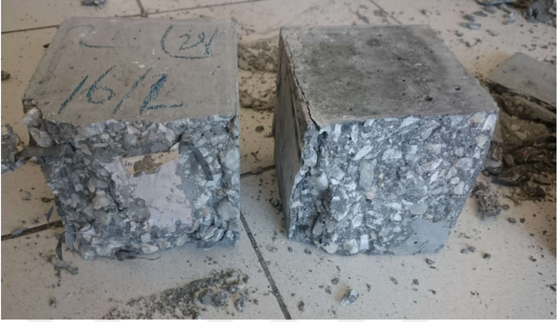
Şekil 4.5. N ve NT karışım kodlu betonların basınç deneyine tabi tutulmuş hali
