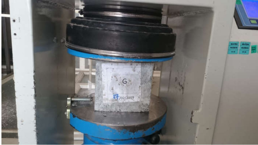
Şekil 3.17. Basınç deneyinde numuneye yük uygulama anı
