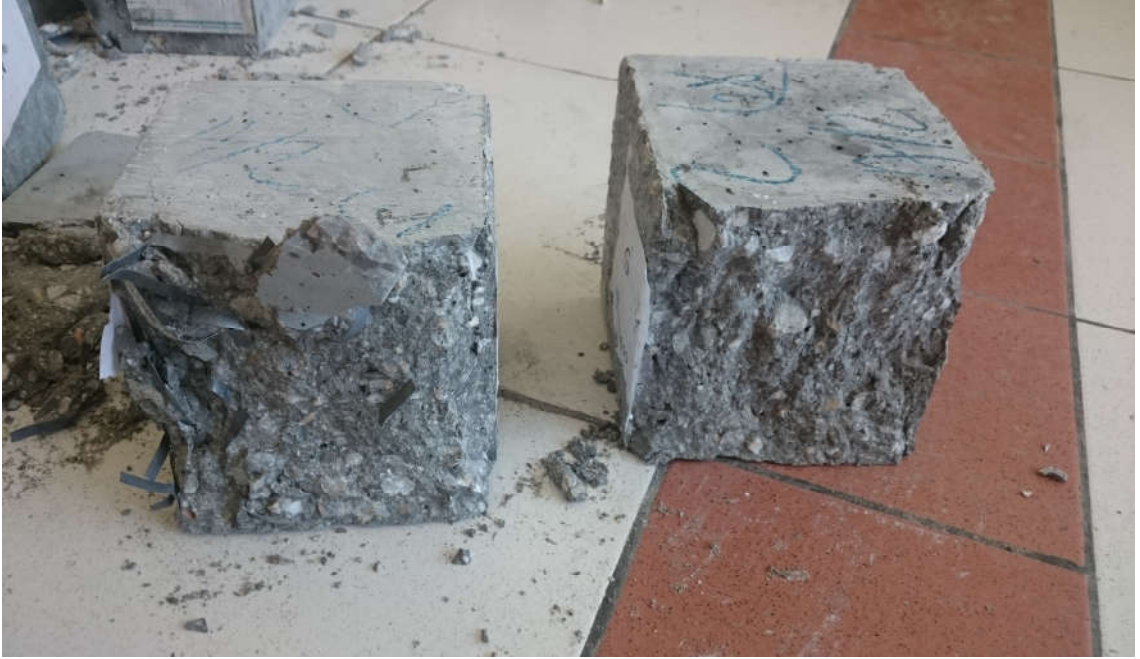
Şekil 4.6. R ve RT karışım kodlu betonların basınç deneyine tabi tutulmuş hali
