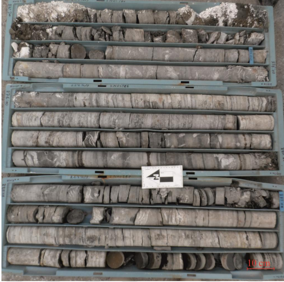
Şekil 4. 15. Katrandedetepe formasyonu, 873-884 m arası gri-yeşil renkli marn kireçtaşı ardalanması, yer yer jips mercekleri ve organik malzeme içeren kiltaşları (TG7 sondajı).
