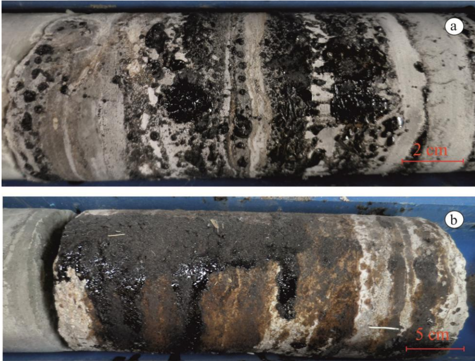
Şekil 4. 26. TG3 sondajından petrol içeren seviyeler, a) 392.5 m petrol emareleri, b) 335.6 m petrol emaresi (sızıntı şeklinde).
