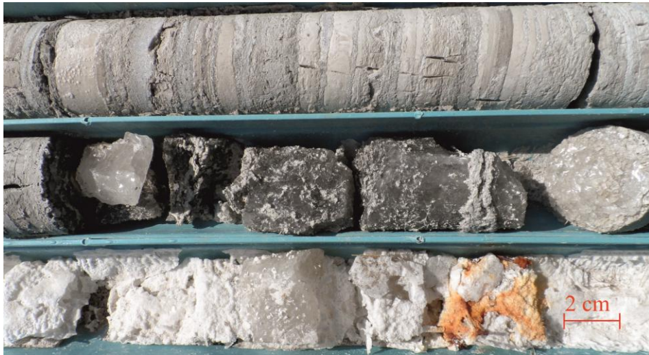
Şekil 4. 24. Kalın tabakalı halit ve ince bantlar şeklinde anhidrit/jips, marn ardalanması (TG6 sondajı).
