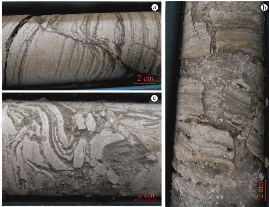
Şekil 4. 38. a) Tektonik hareketlerle oluşmuş mikro fay (TG1 244.7m), b) Kırık ve çatlakların tuz kristalleri ile doldurulması (TG5 563.7m) ve c) Tektonizmaya ilişkili kaotik yapı (TG5 668m).
