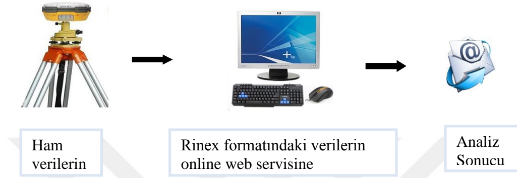
Şekil 4.1 Online PPP web tabanlı değerlendirme servislerinin çalışma düzeni
