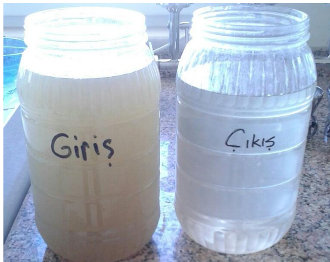
Şekil 5.1. Paket MBR tesisine ait giriş ve çıkış atıksuları
