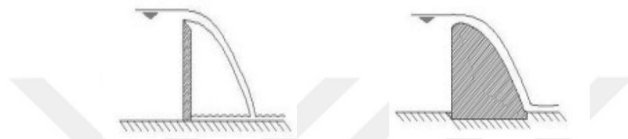
Şekil 2.1. Keskin Başlıklı Dolusavak ve Ogee Tipi Dolusavak Görünümü (Soydan, 2012)
