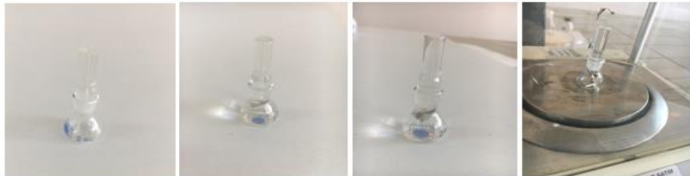
Şekil 3.7. Piknometre yöntemiyle elde ettiğimiz nanofiberlerin yoğunluk ölçümünün şematik gösterimi
