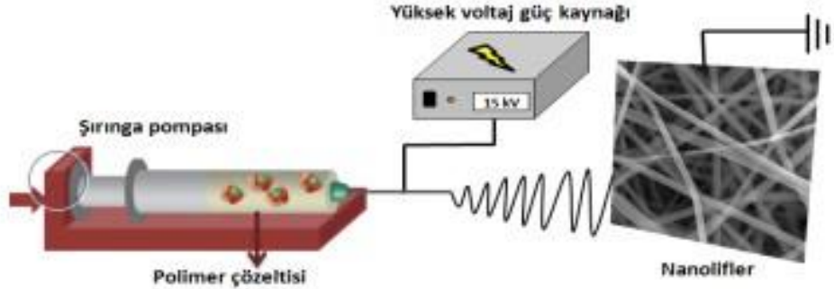
Şekil 1.9. Temel elektrospinin yönteminin şematik gösterimi (Zeynep ve Tamer, 2012)
