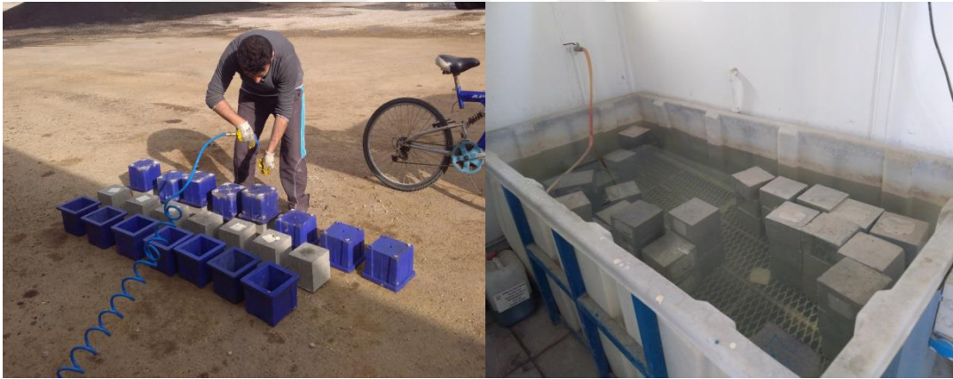
Şekil 4.14. Numunelerin kalıplardan çıkarılması ve kür havuzuna koyulması
