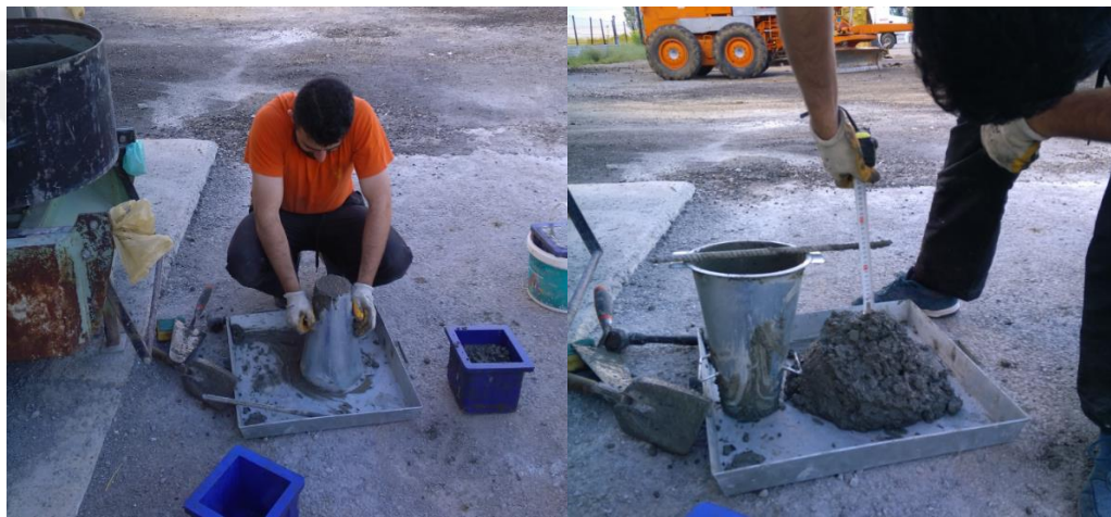
Şekil 4.15. Taze betona slump deneyi yapılması ve çökme değerinin belirlenmesi
