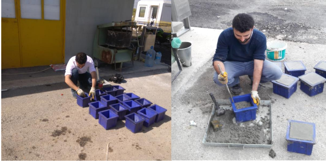
Şekil 4.13. Numune kalıplarının hazırlanması ve taze betonun şişlenmesi
