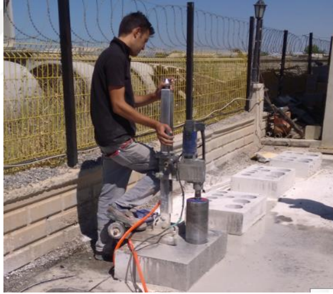
Şekil 4.2. Karot makinesi ve numune alımı
