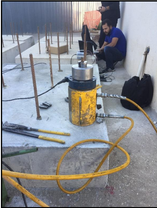
Şekil 5. 19. a, b: Çekip çıkarma deneyleri, Yapılan deney sonucu genel görünüm
