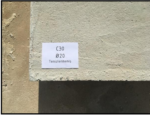
Şekil 5. 11. Beton, donatı ve temizlik parametreleri
