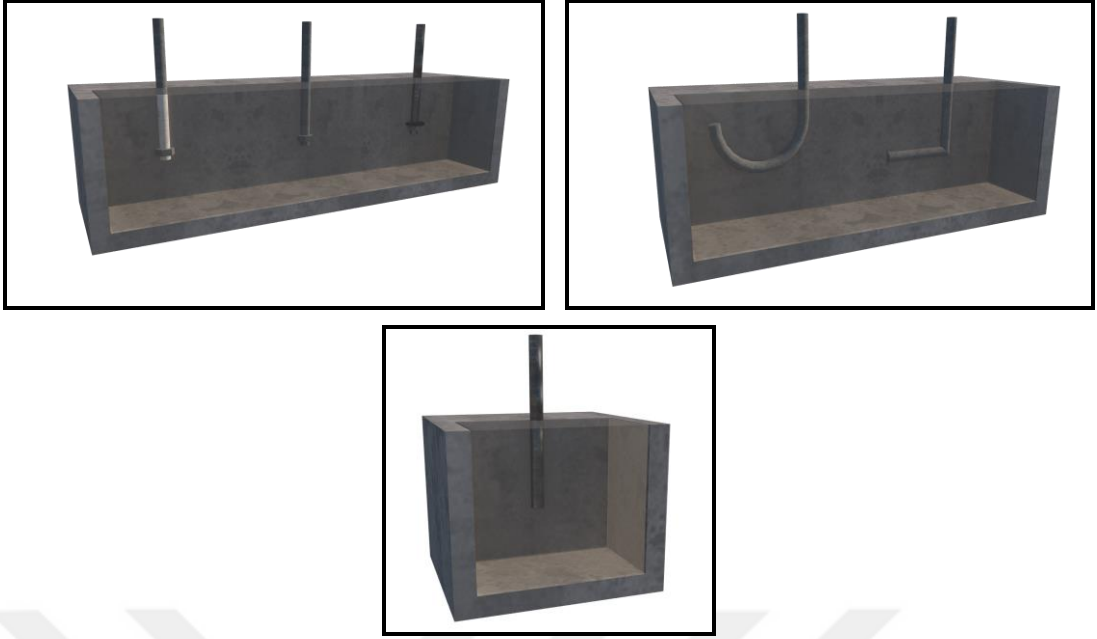
Şekil 3.2. Taze betona uygulanan ankraj tipleri
