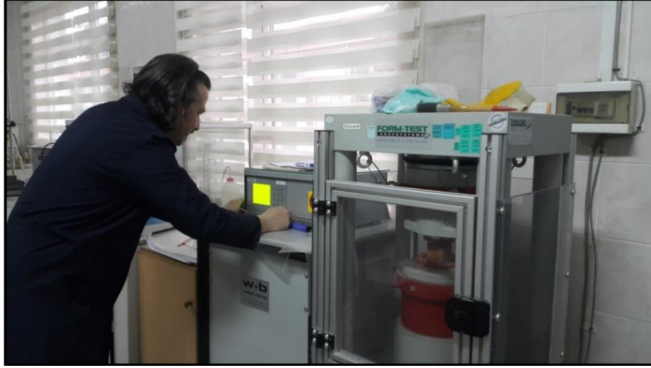
Şekil 3.38. Basınç Dayanım Değeri Ölçümlerinde Kullanılan Pres
