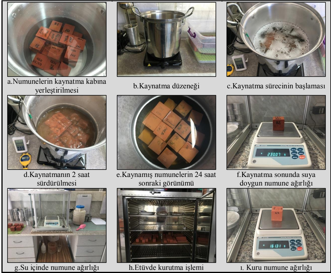
Şekil 3.33. Kaynar suda kütlece su emme deney süreci
