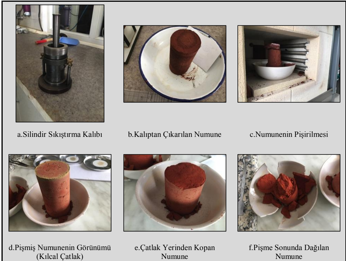
Şekil 3.23. Silindir Kalıp İle Numune Üretim Denemesi ve Oluşan Problemlerin Görünümü
