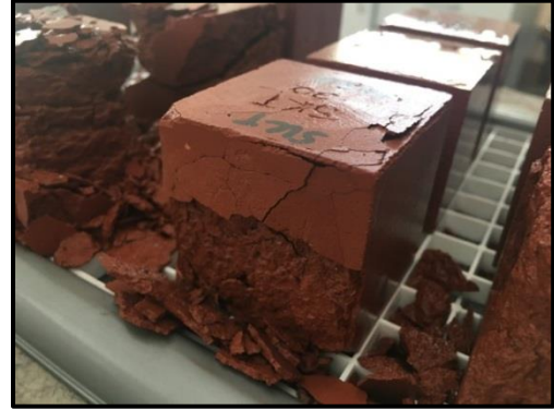
b. "SKT 30 1050 D3" deney sonunda gözlemlenen hasar boyutu
