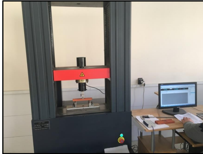
Şekil 3.39. “MOR TESTER” isimli eğilme dayanımı test cihazı
