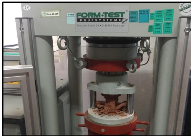
Şekil 3.27. Form-Test Prüfsysteme Markalı Basınç Dayanım Test Cihazı
