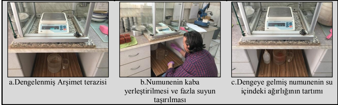
Şekil 3.32. Arşimet terazisi ile su içinde ağırlık tartımı
