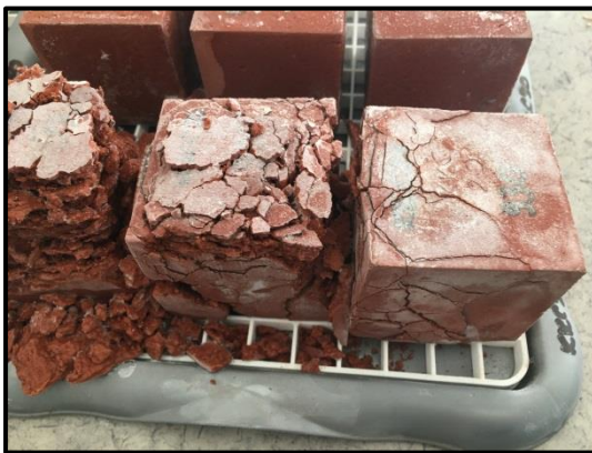
a. "KCC 20 930" isimli numunelerin 6.devir donma sonrası görünümü
