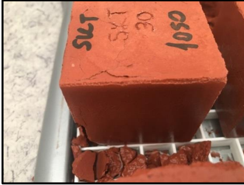
a. "SKT 30 1050 D3" numunesinde 21. devir sonrasında gözlemlenen hasar
