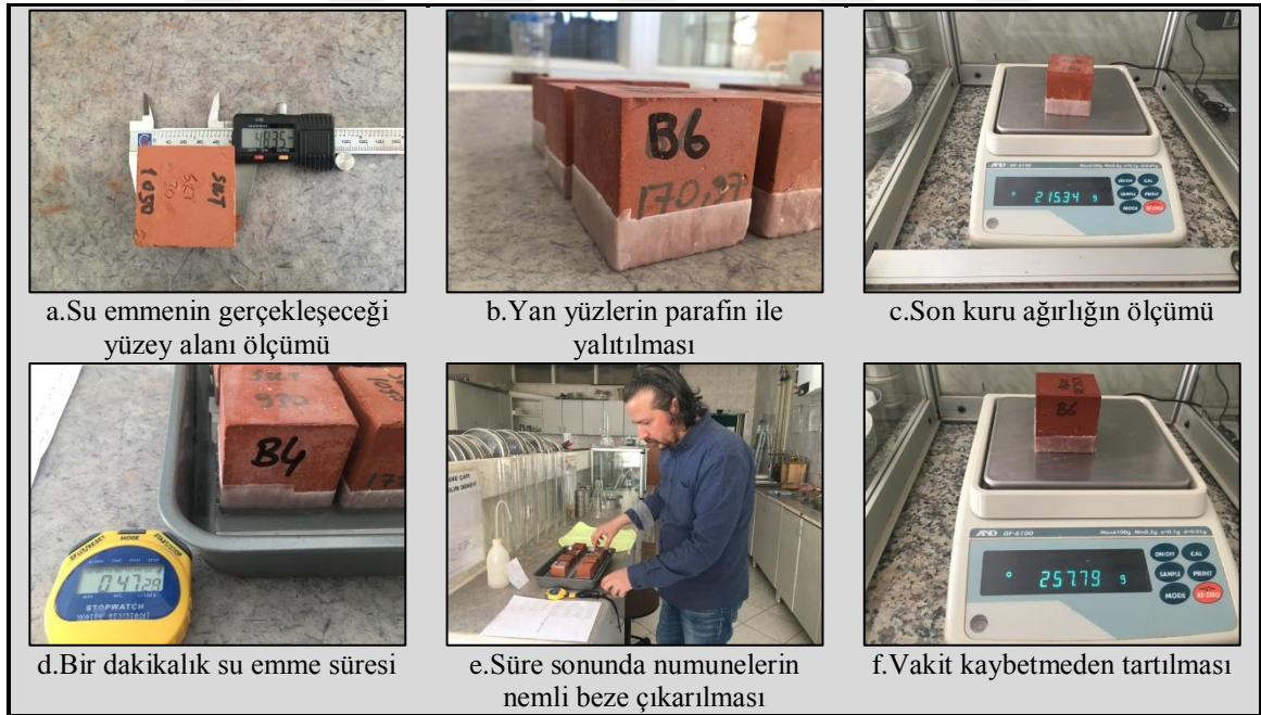
Şekil 3.34. İlk su emme hızı deney süreci
