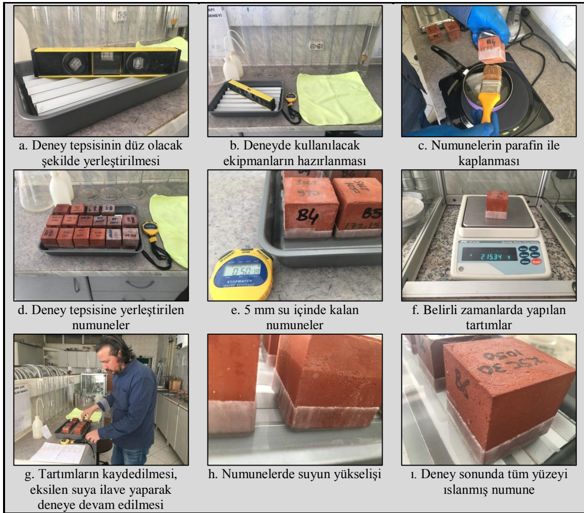
Şekil 3.35. Kılcallık (Kapilarite) deney süreci
