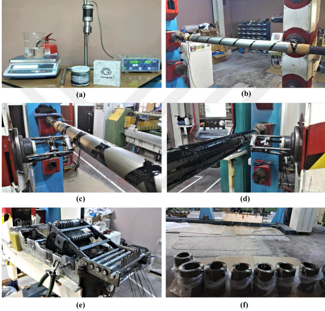
Şekil 6.2 Grafen takviyeli bazalt/epoksi filaman sarım boruların üretimi; (a) grafenin ultrasonik karıştırma işlemi, (b) sarım başlangıcı, (c) ilk tabaka sarım anı, (d) sarım sonu (e) grafen/epoksi reçine banyosunda ıslatılan bazalt elyaf demetleri, (f) bazalt elyaf bobinleri
