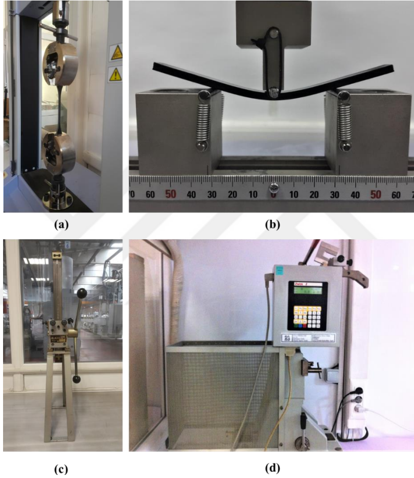
Şekil 6.1 Mekanik test cihazları; (a) çekme, (b) eğilme (c) universal V-çentik açma (d) V-çentikli Charpy darbe
