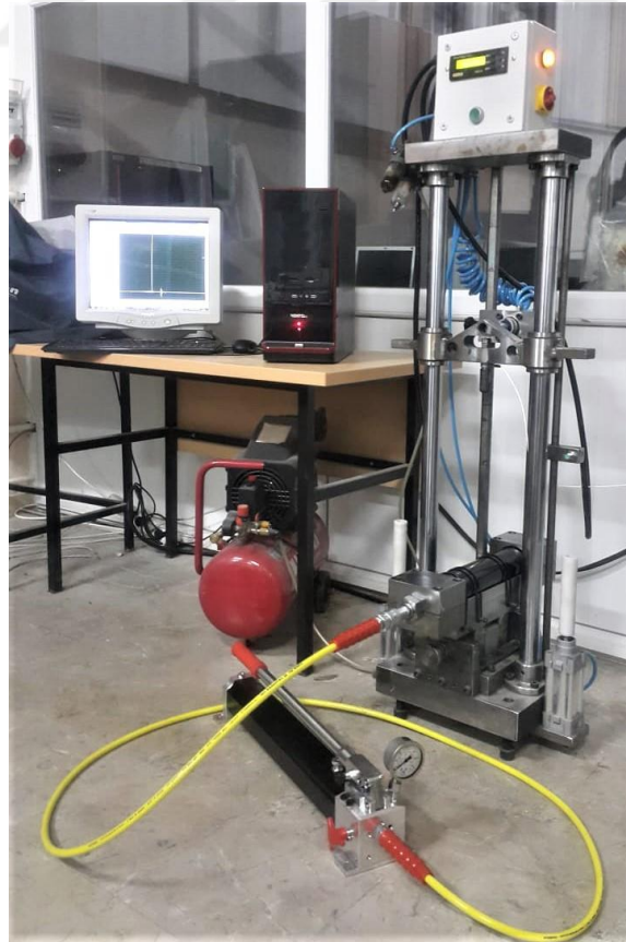
Şekil 6.10 Teğetsel ve aksenal ön gerilme oluşturmak için kapalı-uçlu borulara iç basınç uygulaması
