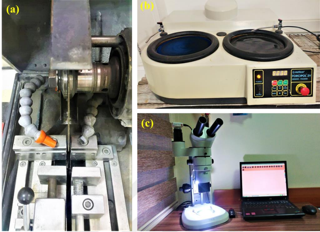
Şekil 6.18 Borularda oluşan hasarların incelenmesi için kullanılan; (a) kesme cihazı ve kesme diski, (b) zımparalama ve parlatma cihazı c) vision marka SX80 stereo mikroskop ve yazılım
