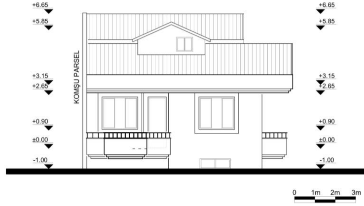
Çizim 4.67. Ali Tetikçok Evi kuzey cephesi (Doğan, 2018)
